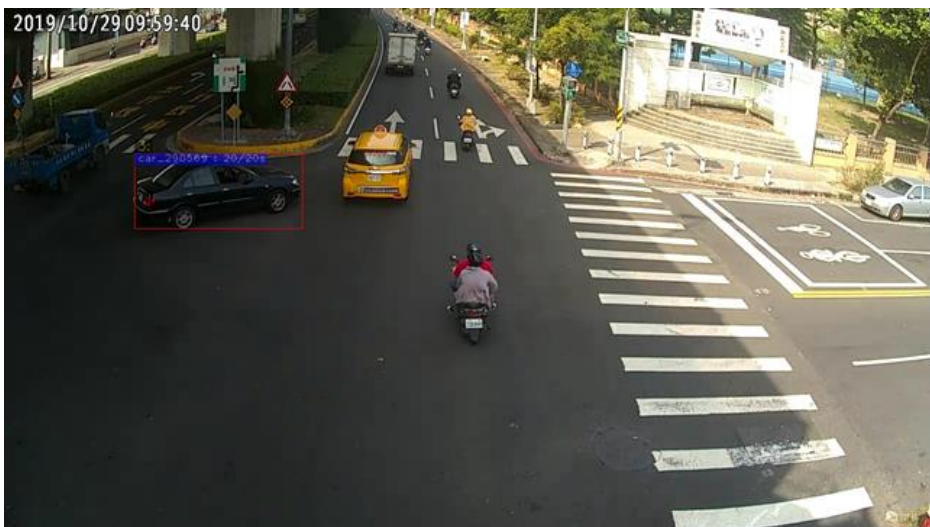
圖 5.8.8 待轉停等、禮讓時間過長導致錯誤路口溢流事件
