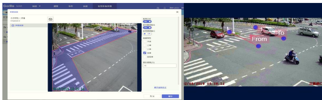
圖 2.3.2 機車違規左轉偵測區域
