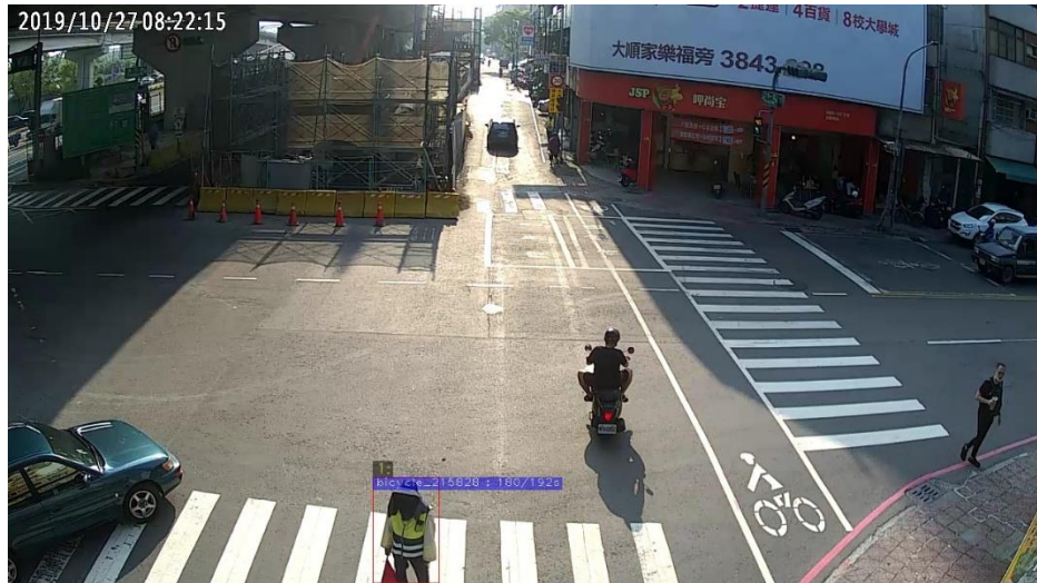
圖 5.8.9 將義交誤偵測為車輛觸發之錯誤異常停留事件
