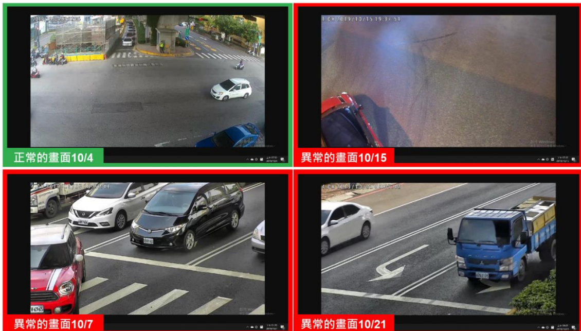
圖 7.2.9 高雄設備影像偏移異常
