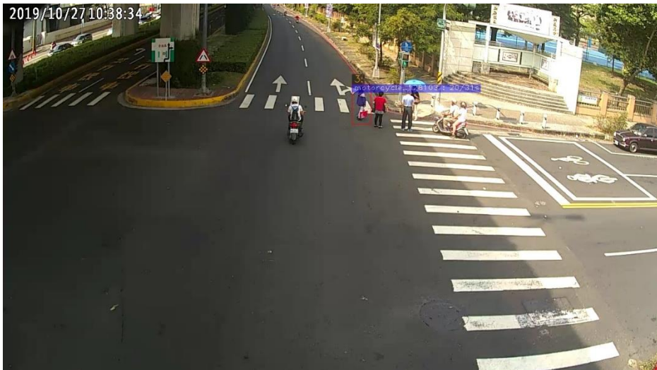
圖 5.8.7 行人停留時間過長導致錯誤路口溢流事件
