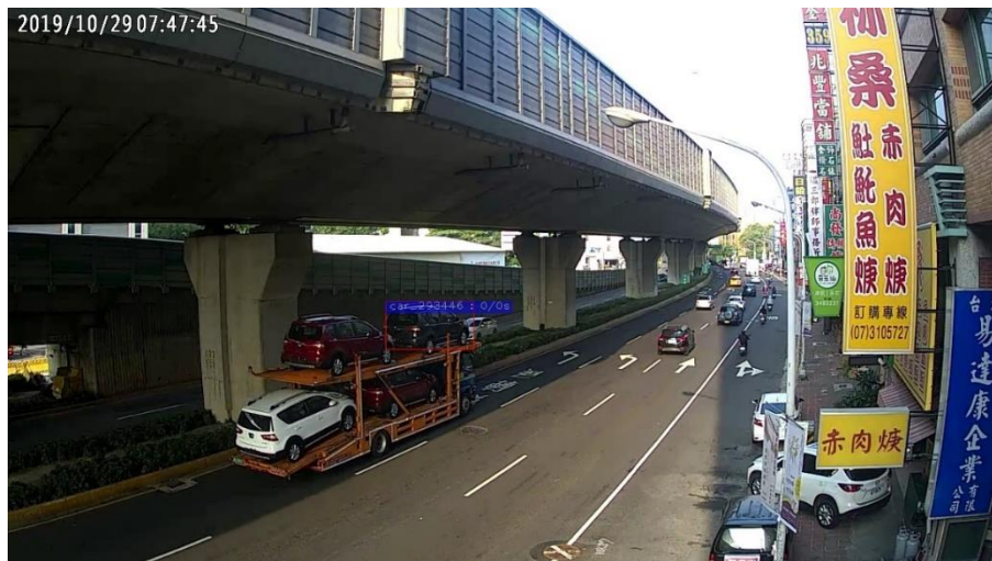
圖 5.8.1 「逆向行駛」事件偵測錯誤辨識對向車道車輛
