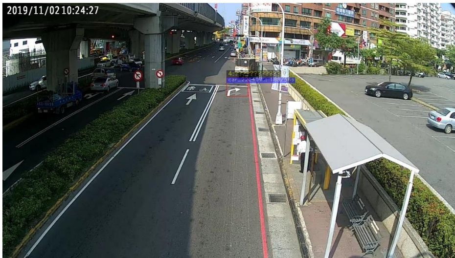
圖 5.8.6 號誌標線錯誤偵測且停留時間過長導致錯誤路口溢流事件
