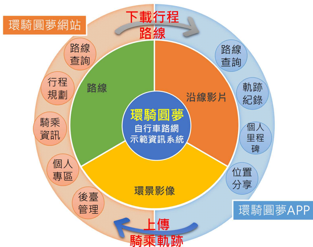
圖 3.4.1 環騎圓夢自行車路網示範資訊系統架構
