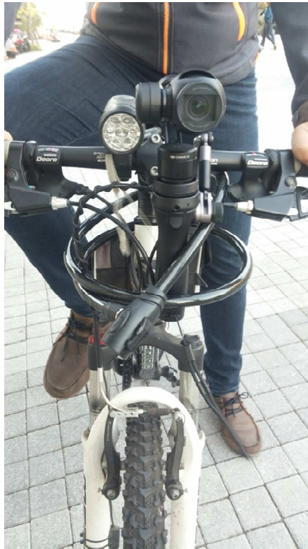
圖 3.2.3 三軸雲台相機架設方式
