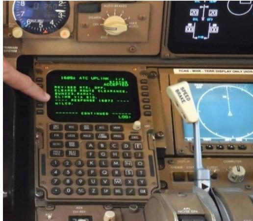
圖 2 駕駛艙螢幕顯示飛航管制員透過數據鏈頒發之指令
