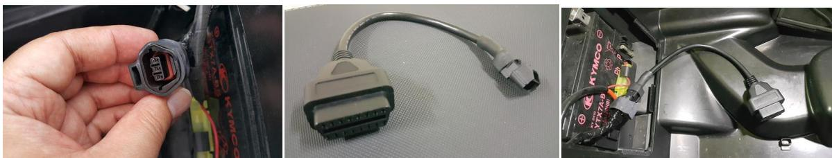
**圖 4.4 (右)光陽 GP125 原廠的 3-pin OBD 接頭，
