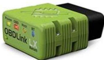
圖 5.9 本研究使用的 OBDLink LX 藍芽 OBD 裝置外觀圖片
