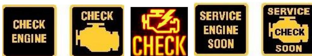
圖 2.2 各類引擎故障與檢查引擎燈號(MIL)圖示
