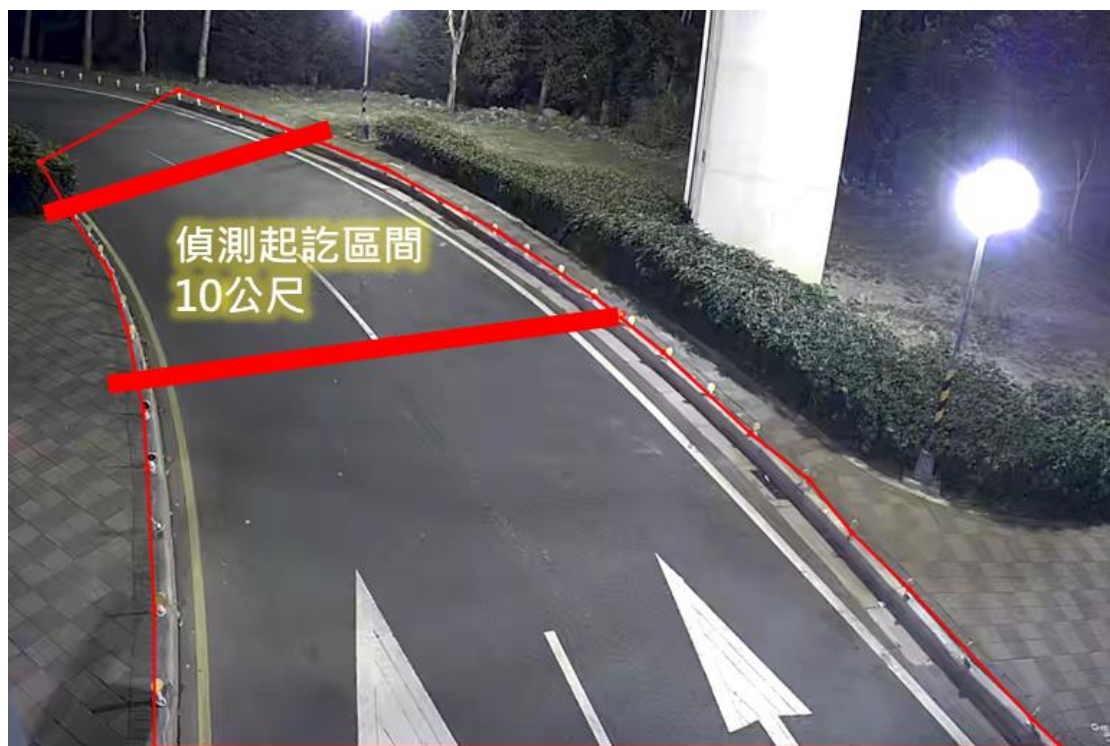
圖 3.1.14 偵測線劃設方式
