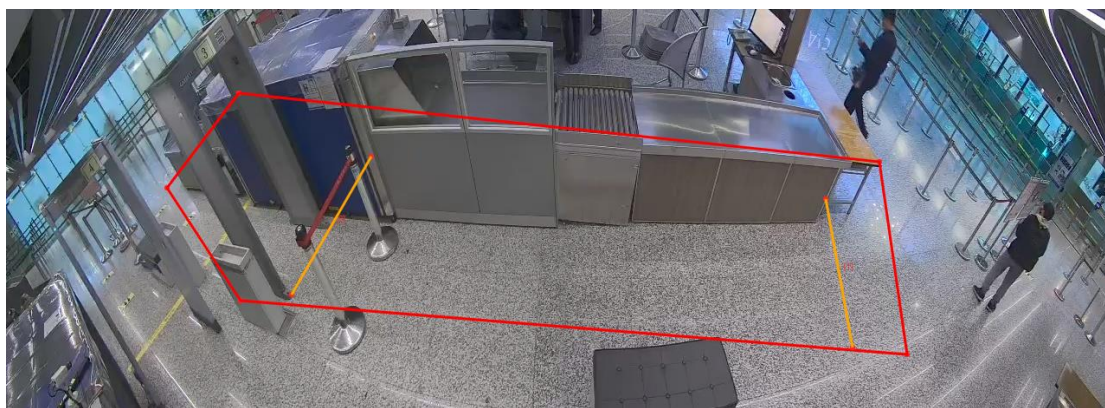
圖 5.2.4 安檢區 AI 影像辨識偵測設備偵測畫面
