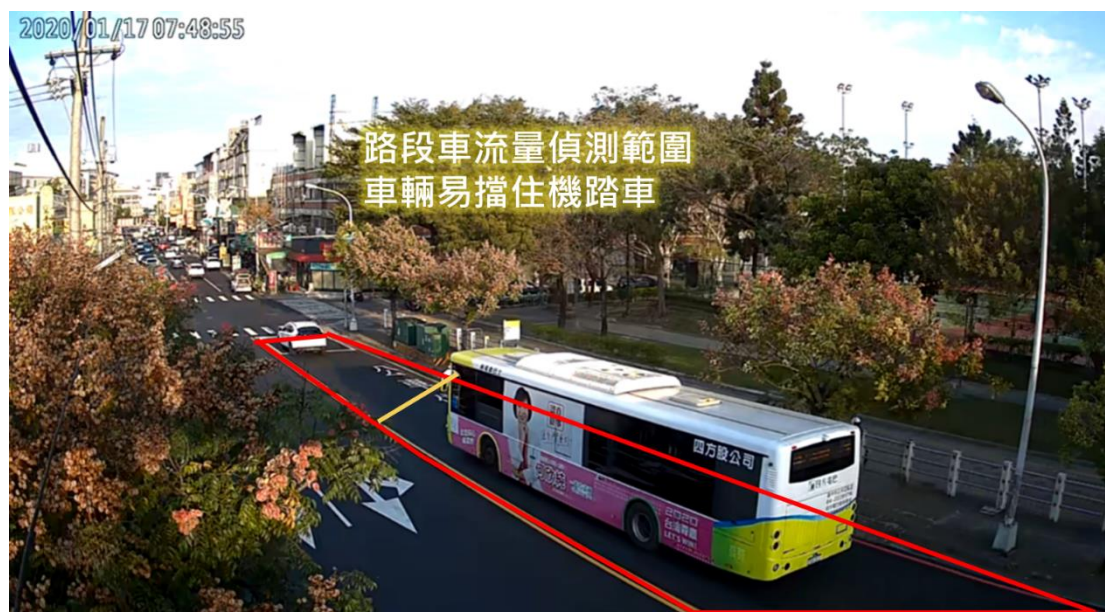
圖 3.1.12 機踏車遭大型車遮蔽現象
