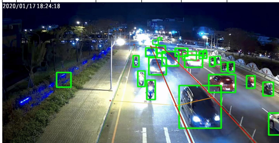
圖 3.1.13 偵測設備正向偵測路段車流量
