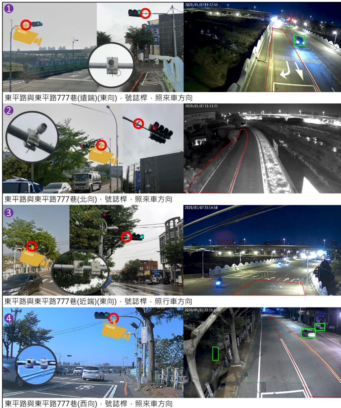
圖 4.2.10 東平路與東平路 777 巷路口(紫 1~4)偵測設備架設位置與畫面
