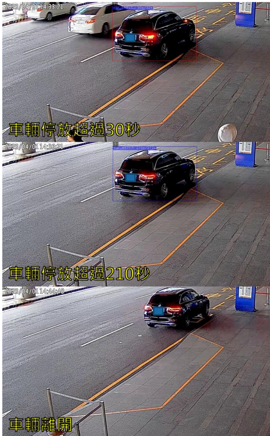
圖 5.2.3 入境臨停區 AI 影像辨識偵測設備偵測畫面
