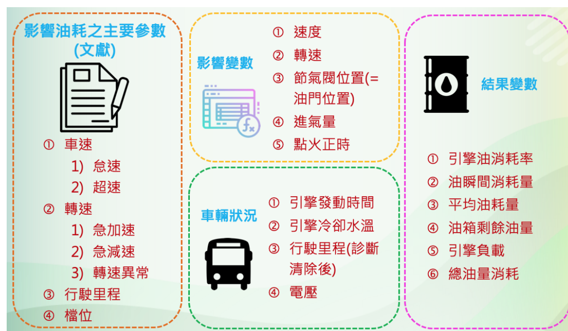
圖 3.12 OBDII 欄位規劃說明
