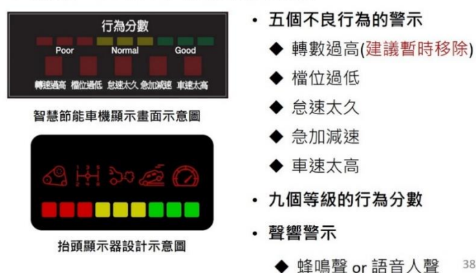
圖 4.6 智慧節能車機螢幕與抬頭顯示器警示項目
