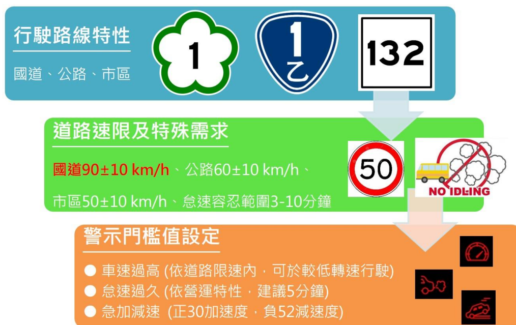
圖 3.4 節能警示門檻值設定流程(路線特性)
