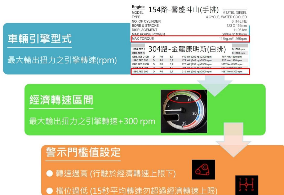
圖 3.3 節能警示門檻值設定流程(車輛特性)
