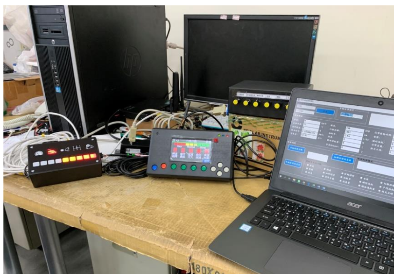
圖 3.23 OBDII 模擬器確認警示門檻值
