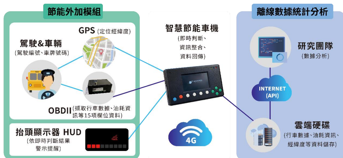
圖 3.1 智慧節能車機軟硬體開發關聯性及功能說明
