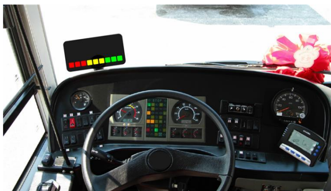
圖 3.5 抬頭顯示器安裝示意圖
