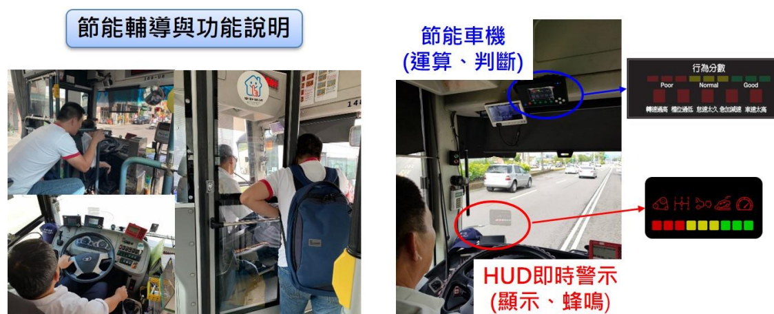
圖 3.24 實車操作確認警示門檻值
