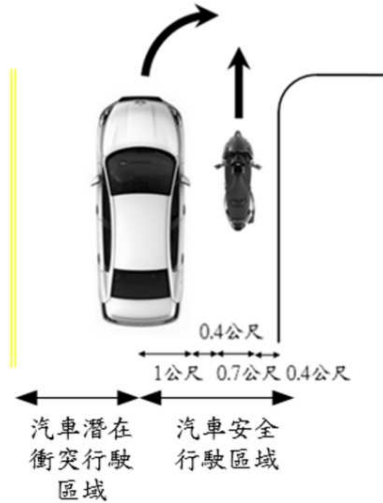
圖 3-13 汽機車併行所需最小淨間距
