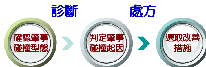
圖 3-3 易肇事路口改善的診斷與處方相連結架構
