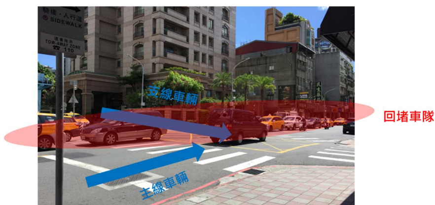
圖 4-2 回堵車隊妨礙視線示意圖
