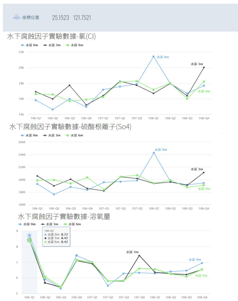
圖 3 水下腐蝕試驗歷線圖資訊(一)-以基隆港 E2 為例
