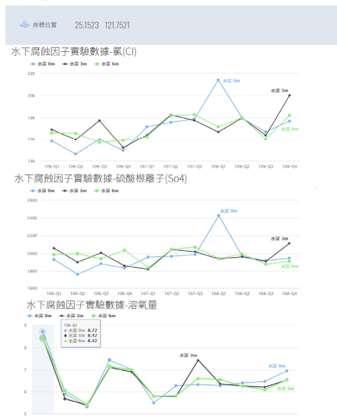
圖 4.76 水下腐蝕試驗歷線圖資訊-1（基隆港 E2 為例）
