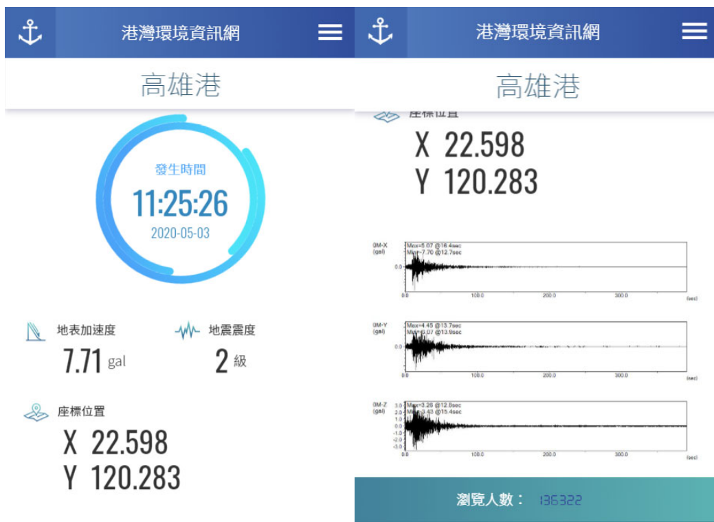
圖 4.68 行動裝置版-港區地震資訊
