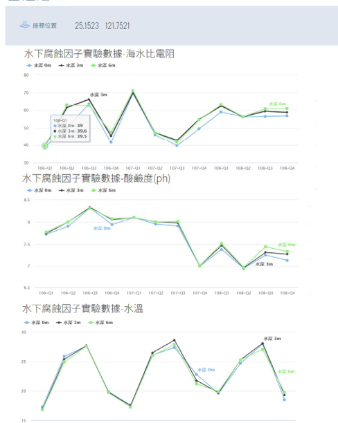
圖 4.77 水下腐蝕試驗歷線圖資訊-2（基隆港 E2 為例）
