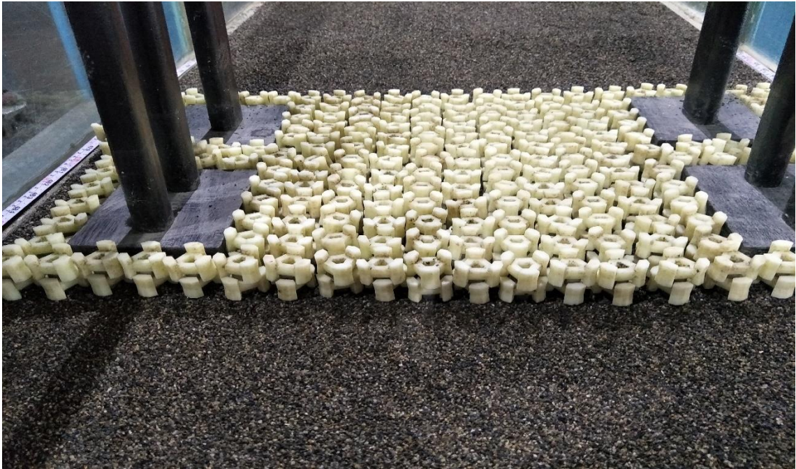
圖 2.12 現況保護措施模型鋪設
