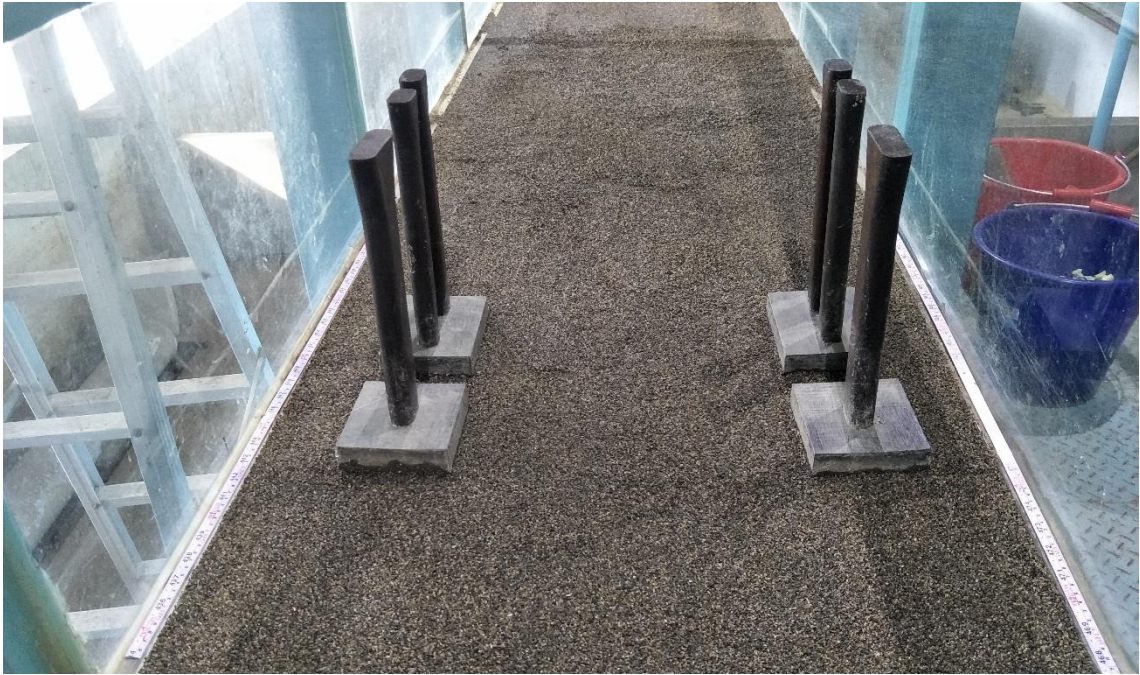
圖 2.14 無保護措施橋墩鋪設
