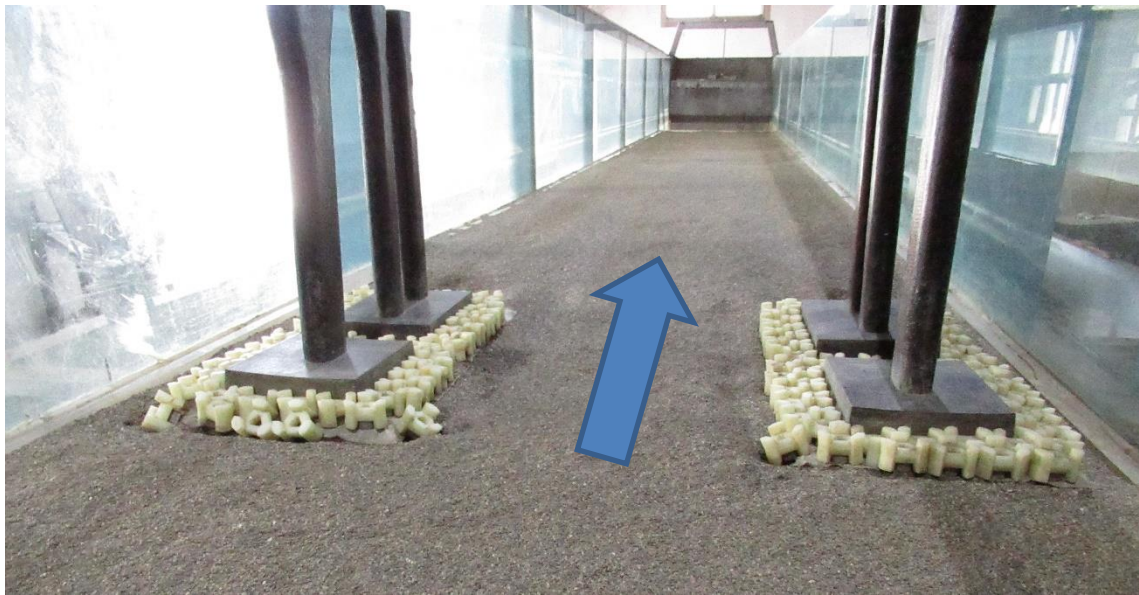
圖 5.11 鼎型塊結合地工織布圍繞橋墩基礎保護方案沖刷情形
