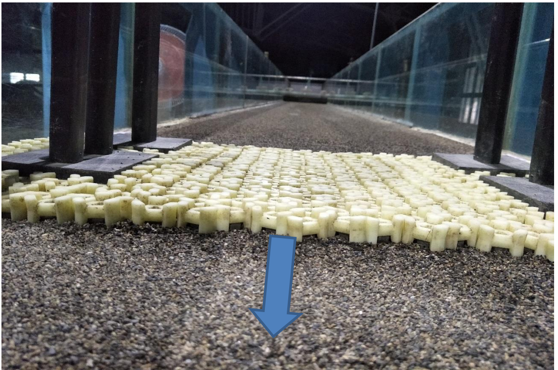
圖 2.19 一層鼎型塊+織布保護措施模型鋪設
