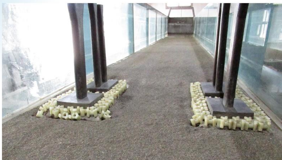
鼎型塊結合地工織布圍繞橋墩基礎保護方案沖刷情形
