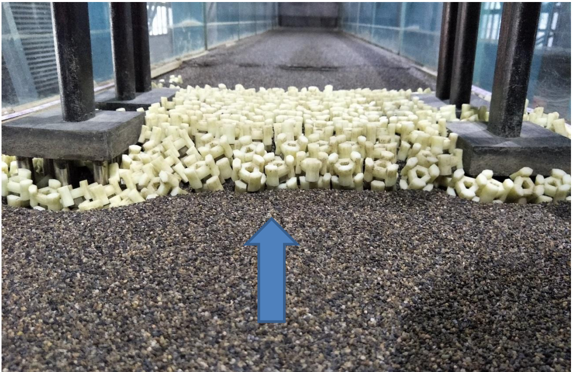
圖 2.15 現況保護措施基礎上游沖刷情形
