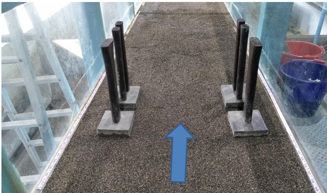
圖 5.2 橋墩鋪設情形
