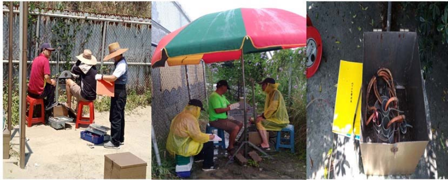
圖4-1布袋分層沉陷及水位量測 (以無線電波感應式層別沉陷儀)
