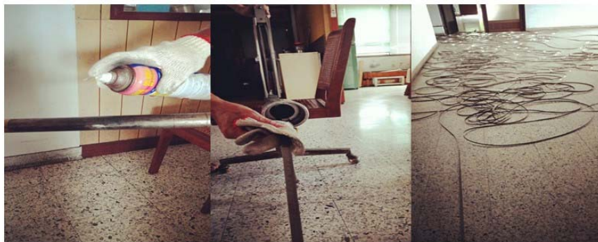
圖 4-2沉陷儀及沉陷尺保養工作
