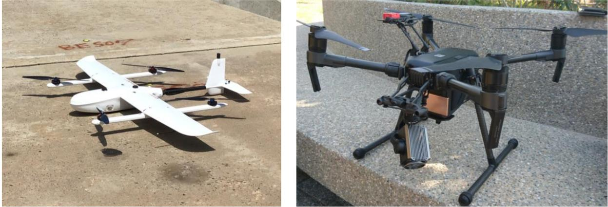
圖 2.6 無人機形式(左：複合式；右：多旋翼式)
