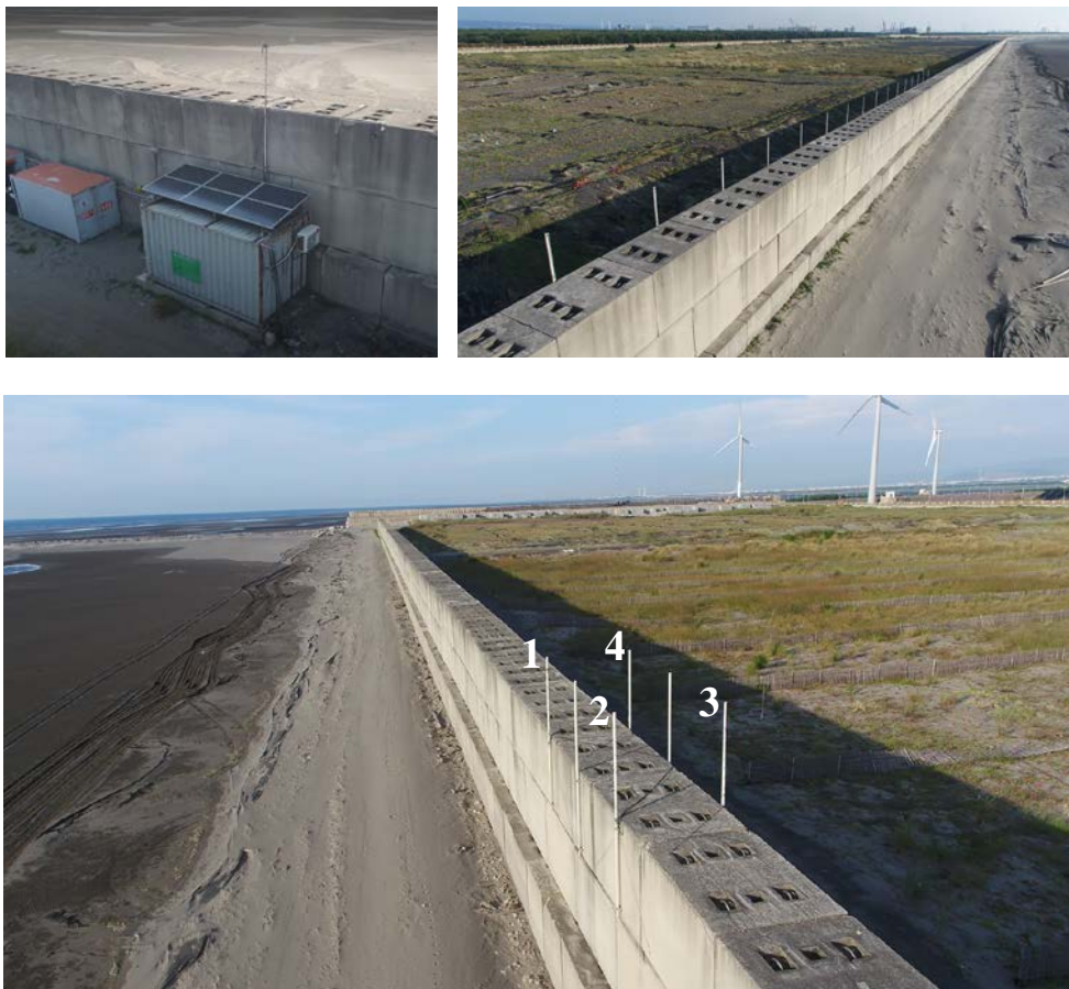
圖 2.2 雷達外觀 機房(左上)、接收天線(右上)、發射天線(下圖)
