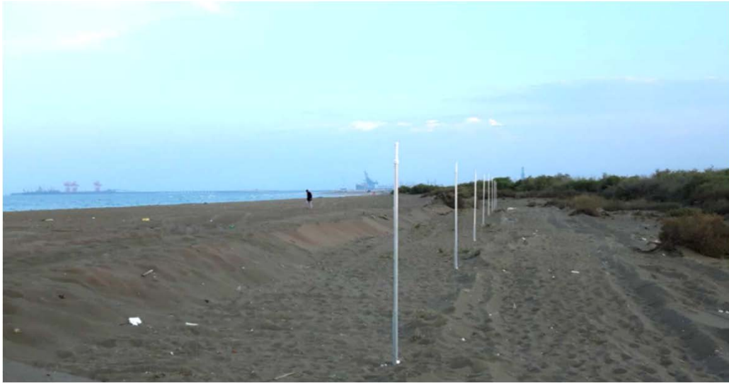
圖 2.16 指向性陣列雷達接收天線陣列示意圖
