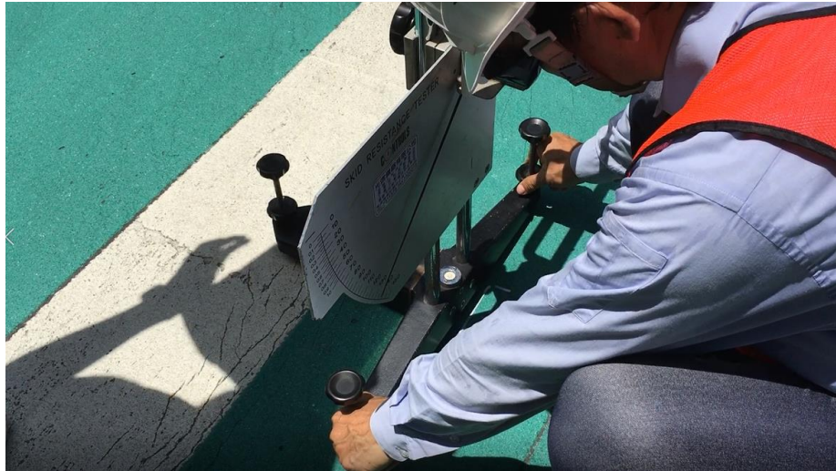
圖 27 調整儀器水平
