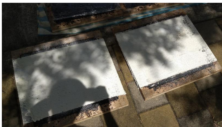
圖 43 取樣完成之標線材料試體
