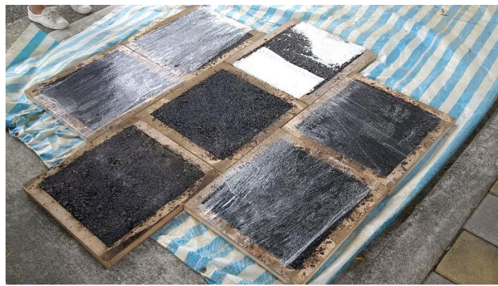
圖 41 現地標線材料取樣作業準備工作
