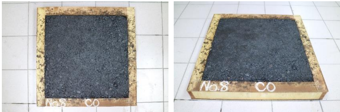
圖 36 製作完成之實驗室平版試體 [118]
