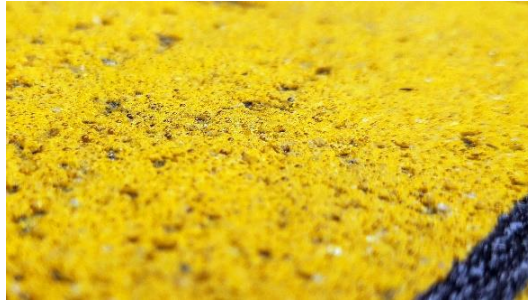
冷塑標線-突起顆粒小而較為密集
