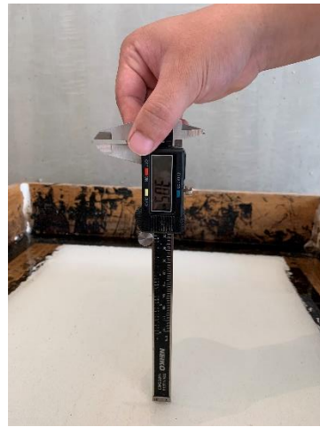
(D)量測水膜厚度結果
