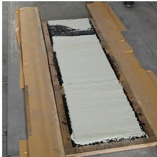
圖 40 取樣時需準備兩塊犧牲用之試體放在前後位置
