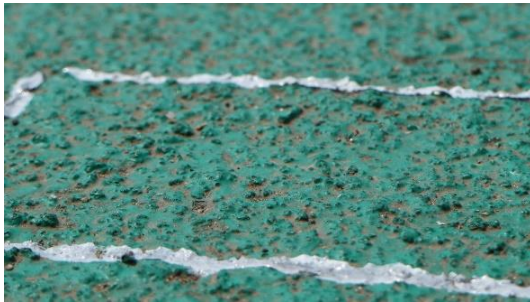
冷塑標線-突起顆粒大而較為分散
