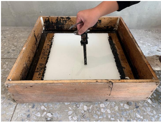
(C)使用游標卡尺量測水膜厚度
