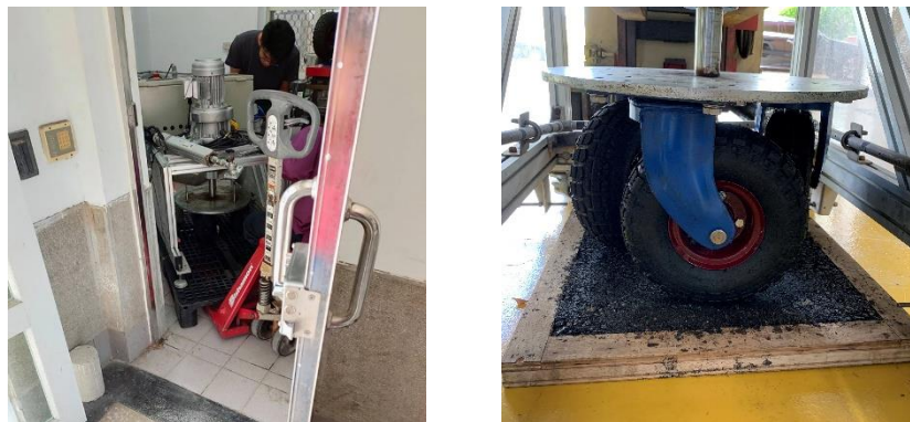
圖 47 三輪式旋轉磨耗儀加速磨耗儀改裝作業
