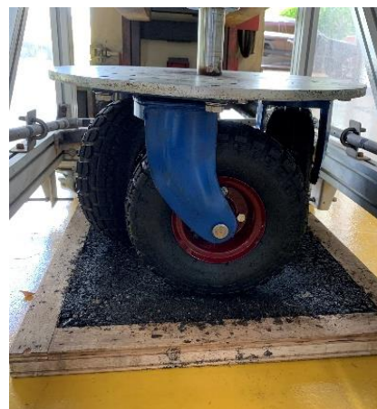
附錄圖 1 三輪式旋轉磨耗儀(WTPD)
