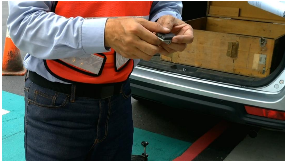
圖 25 確認橡膠滑塊磨損情形
