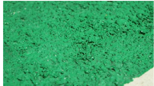
冷塑標線-突起顆粒大而較為分散
