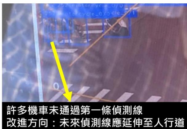
圖 3.2.9 樂業路東行，機車右轉準確率較低圖示
