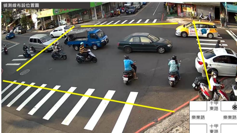
圖 3.2.7 臨時性設備現場偵測線劃設
