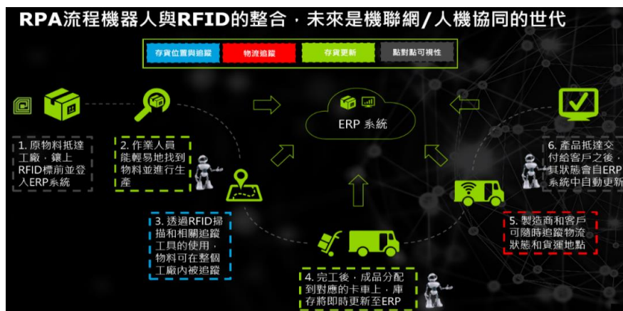
圖 2.7 RPA、RFID 設備、ERP 系統整合圖
