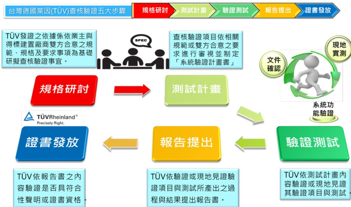
圖 4.2.4 查核驗證作業流程
