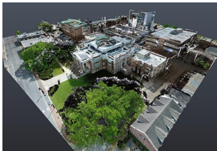
圖 3.2-4 利用 LiDAR-SLAM 結合無人機進行掃描
