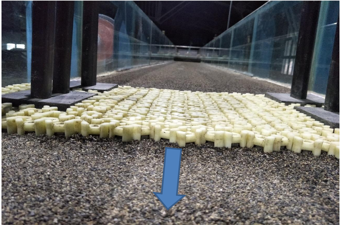
圖 2.21 一層鼎型塊+織布保護措施模型鋪設
