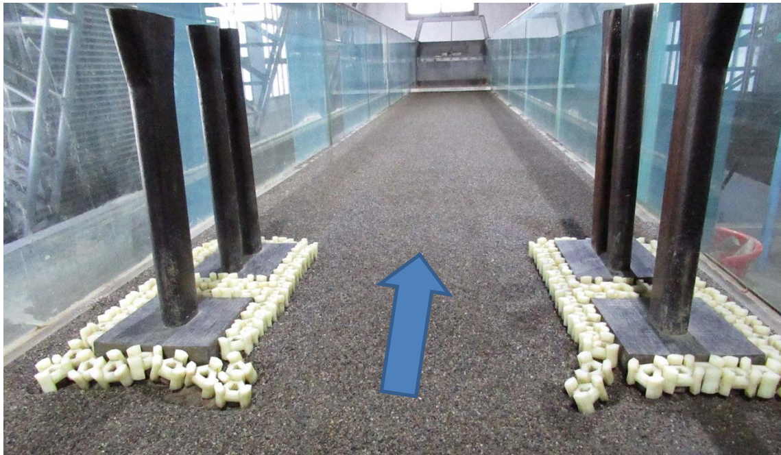
圖 6.37 埋設織布圍繞橋墩基礎上鋪一排鼎型塊保護方案沖刷情形
