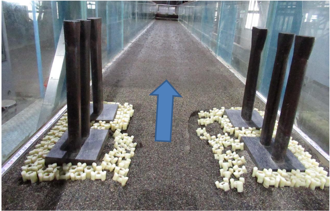
圖 6.8 二排鼎型塊圍繞橋墩基礎保護方案沖刷情形
