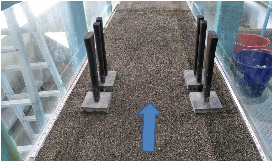
圖 6.2 橋墩鋪設情形
