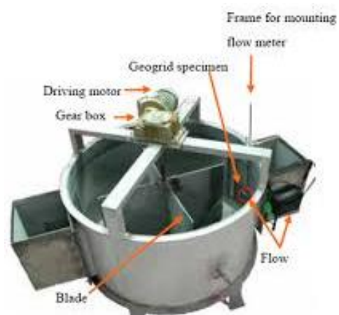
圖 2.6 直徑 1.5 m 高 1.0 m 之圓形流槽
