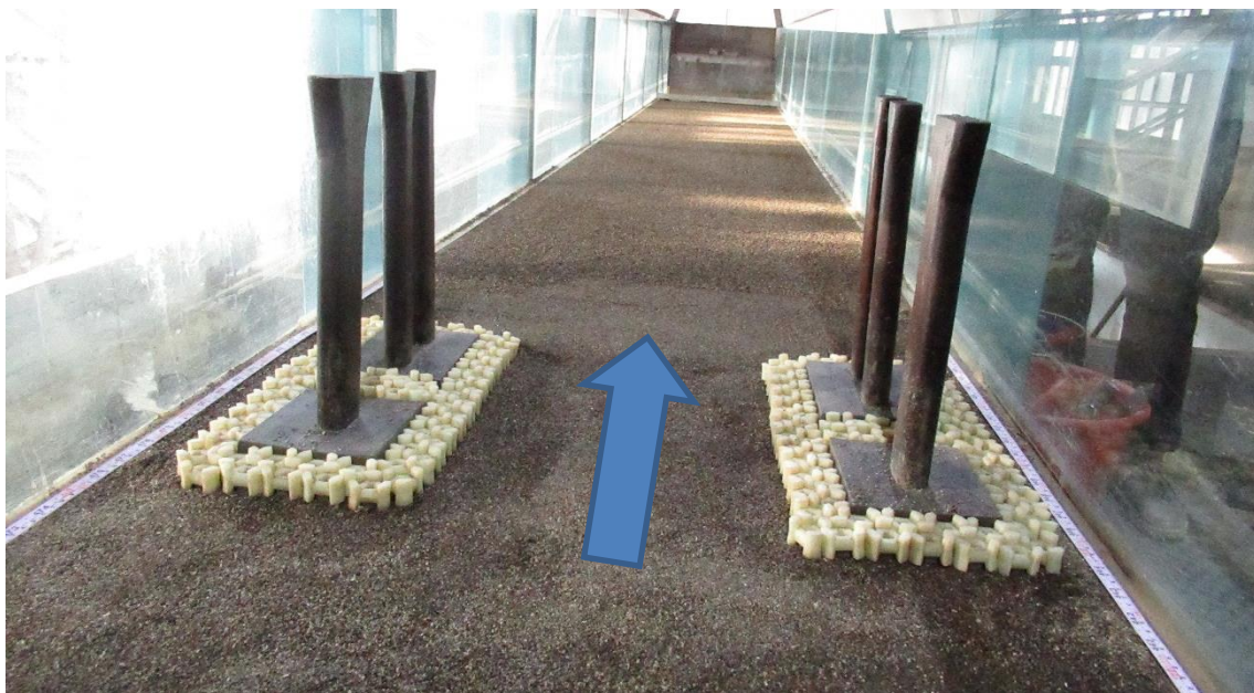
圖 6.33 覆土將織布埋入並於上鋪二排鼎型塊保護方案試驗模型
