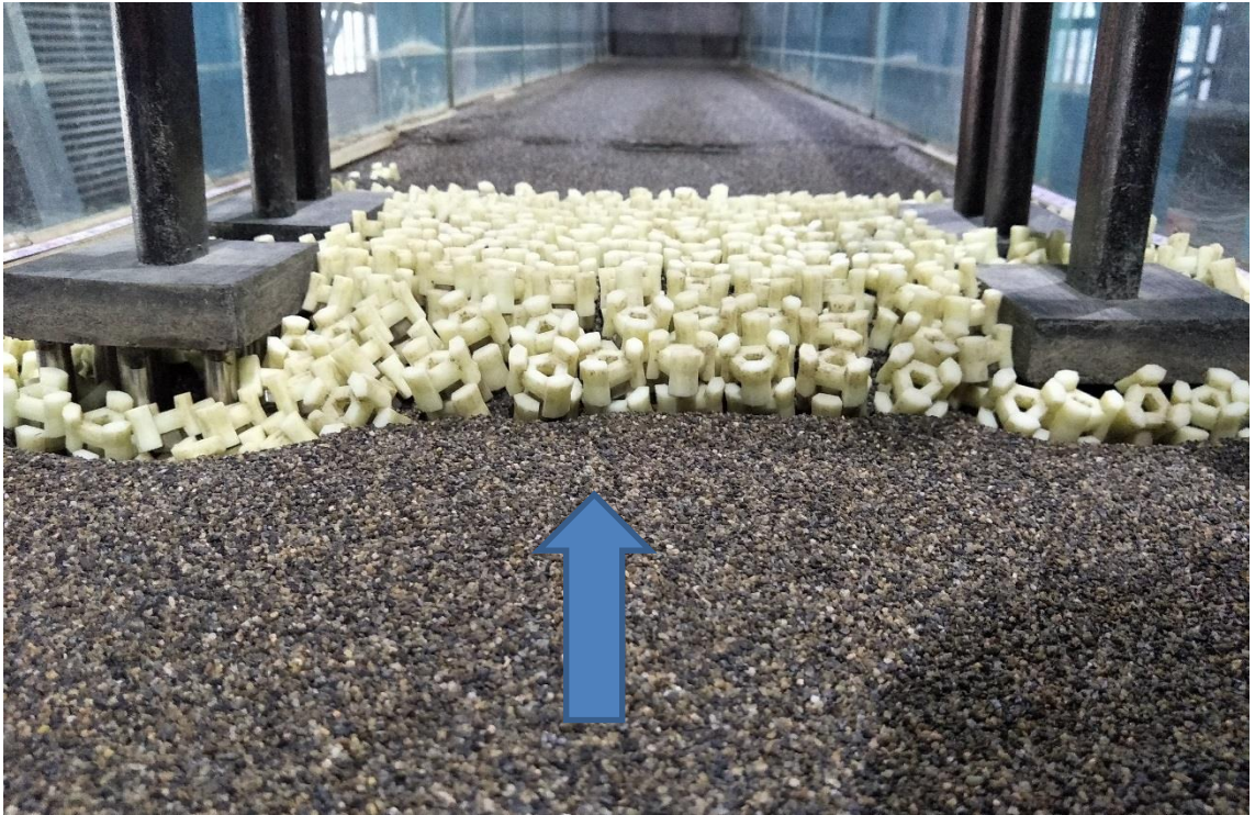
圖 2.17 現況保護措施基礎上游沖刷情形
