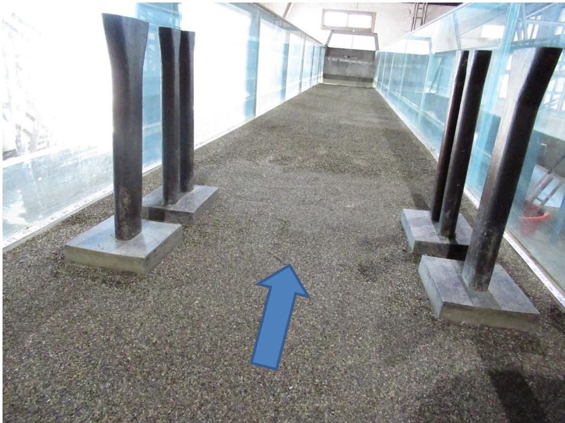
圖 6.4 無保護工試驗模型
