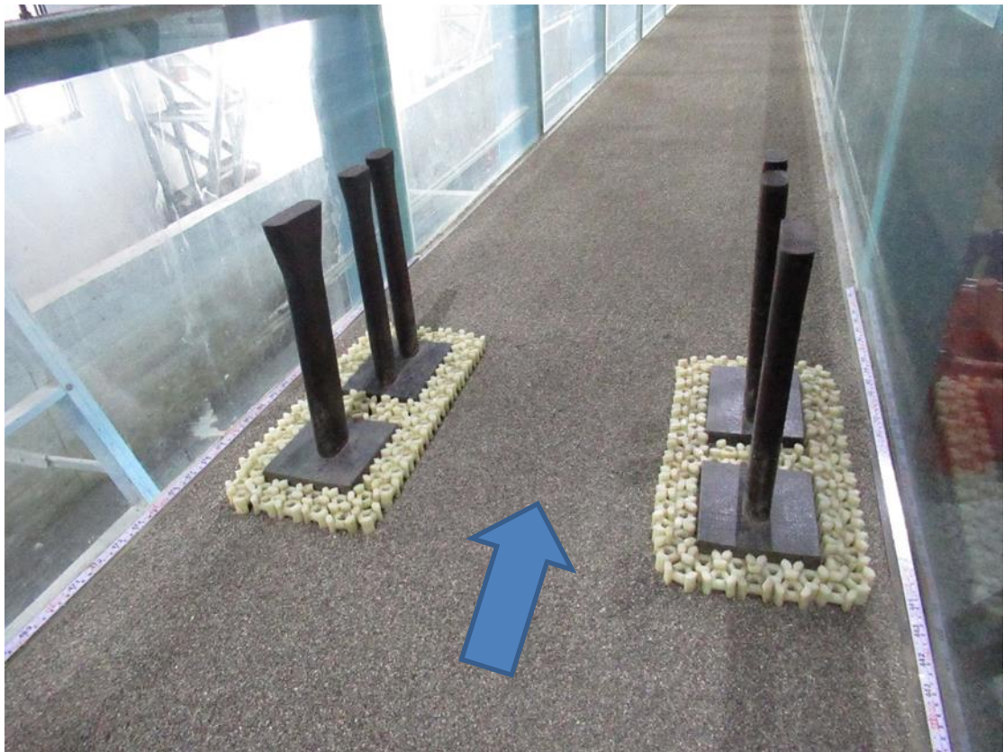
圖 6.7 二排鼎型塊圍繞橋墩基礎保護方案試驗模型
