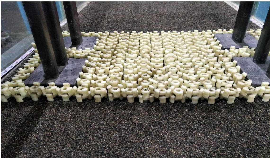
圖 2.14 現況保護措施模型鋪設
