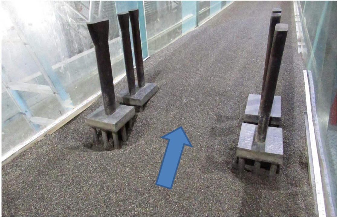
圖 6.5 無保護工基礎沖刷情形
