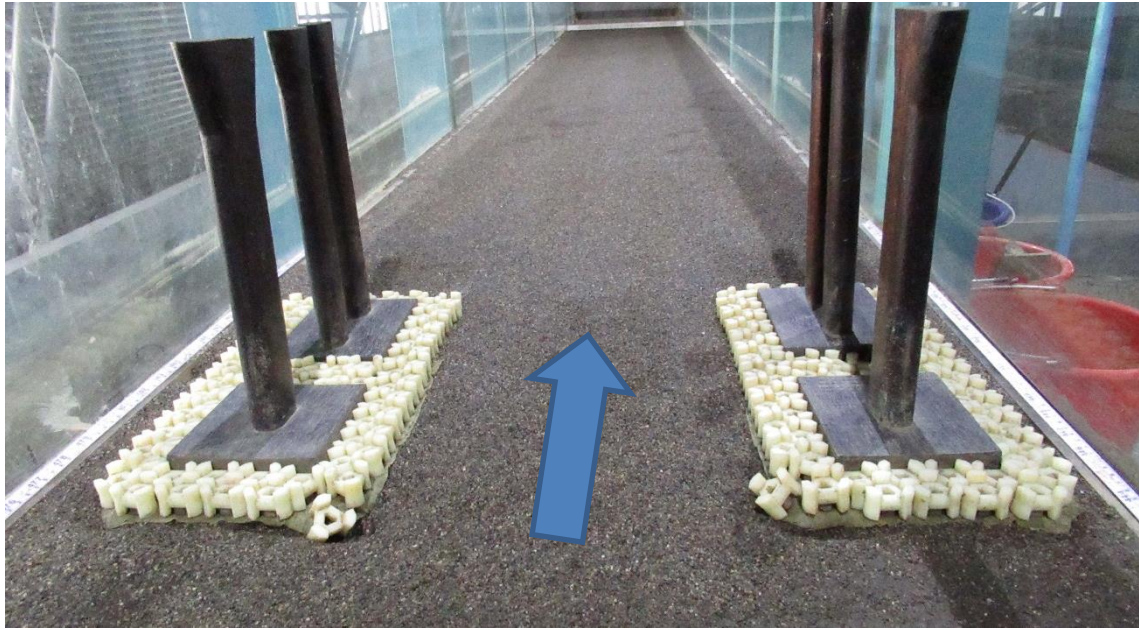
圖 6.20 二排鼎型塊鋪織布下游側鼎型塊降階保護方案沖刷情形
