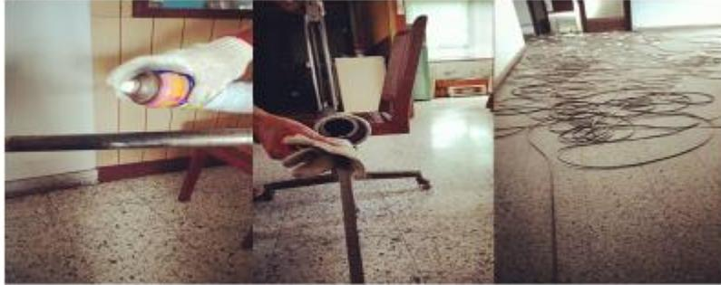
圖 4-2沉陷儀及沉陷尺保養工作
