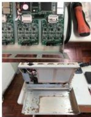
中央集錄系統故障(螞蟻築巢痕跡)
