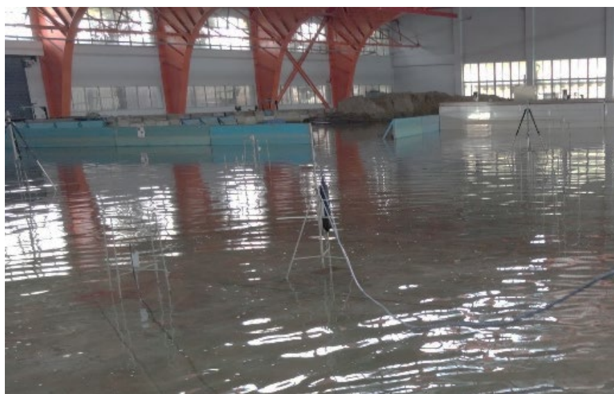
圖 2.9 挪威 Vectrino 流速計
