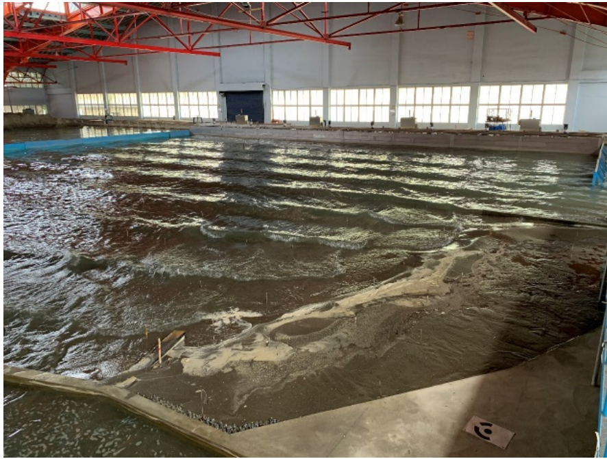
圖 3.6 北淤沙區大量漂沙有堆積情形
