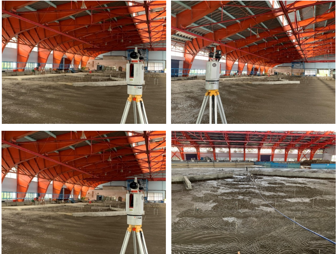
圖 7 地面光達掃描作業情況
