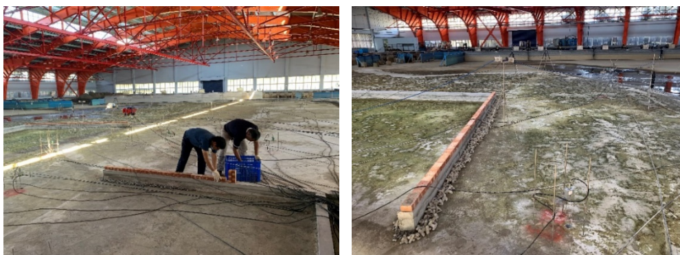
圖 3.19 近程方案胸牆墊高試驗影像
