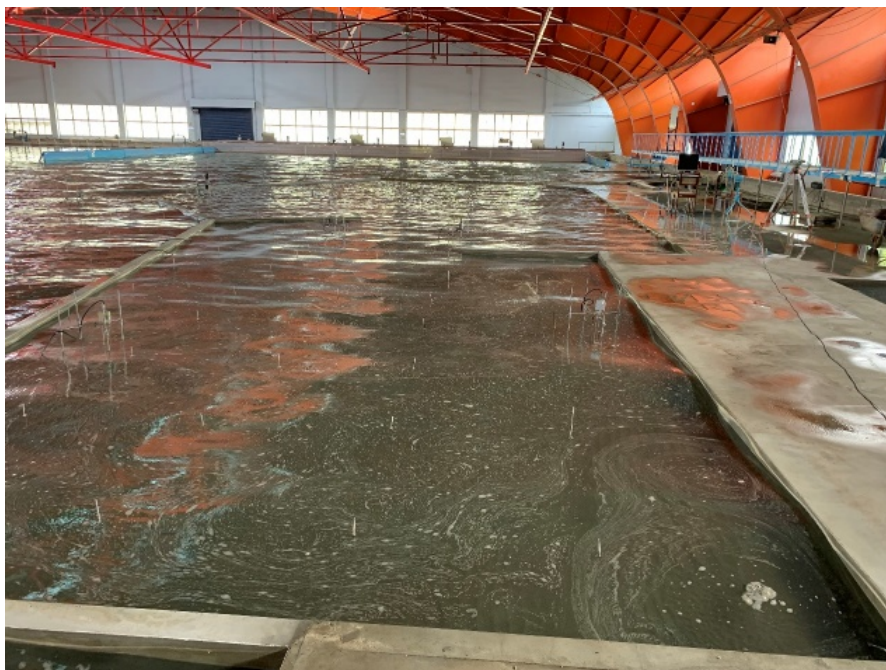
圖 3.7 LNG 接收區域內波浪較為靜穩
