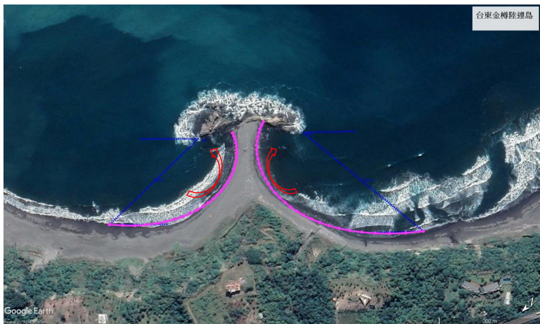
金樽漁港_20180115 離岸堤效應_細平_陸連島靜態岬灣_1X.tif
