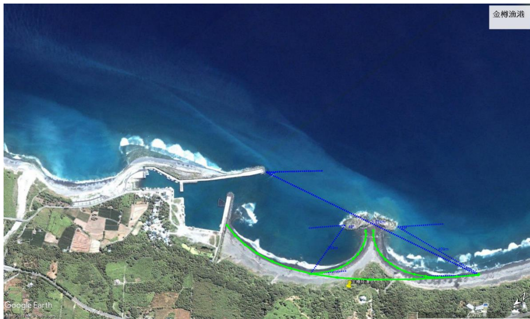
金樽漁港_20130819_離岸堤效應_陸連島_靜態岬灣_2X.tif
