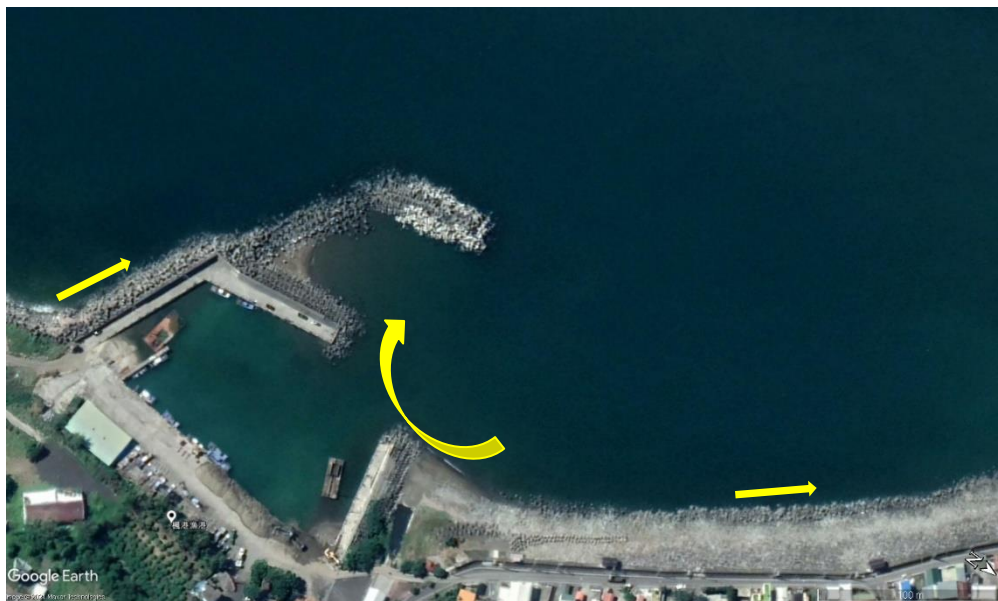
楓港漁港_Google Earth_細平_半離岸堤_繫岸沙洲_2021_11 優. jpg
