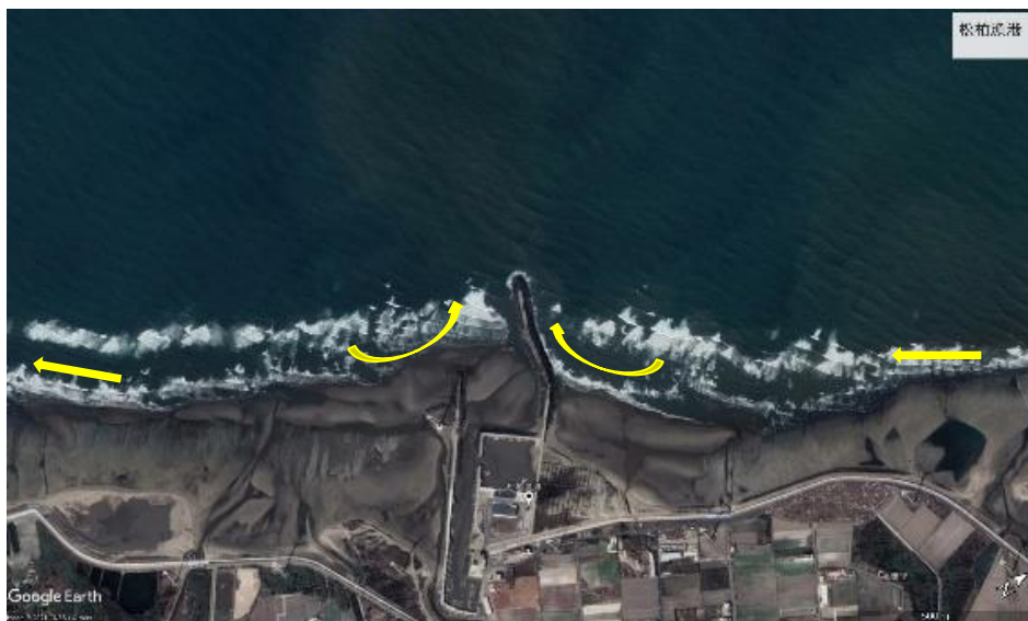
圖 4-80 臺中松柏漁港高潮位(上)及低潮位(下)期間港口外廓防波堤兩側因「離岸堤效應」衍生碎波沖刷環流作用所造成沙舌型型態之淺灘淤積
