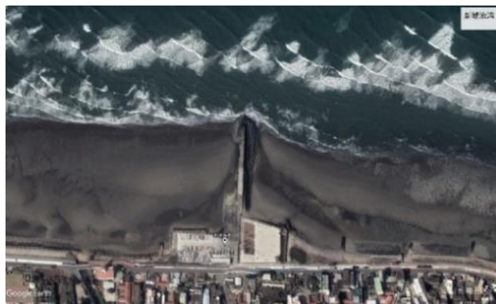
圖 4-78 苗栗新埔漁港高潮位(上)、中潮位(中)及低潮位(下)期間港口外廓防波堤兩側因潮間帶內偏正向入射波浪碎波衍生沖刷流作用所造成平直型態之淺灘淤積
