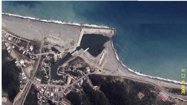
圖 1-7 近岸港口因離岸堤效應造成的港口淤塞與海灘沖蝕
