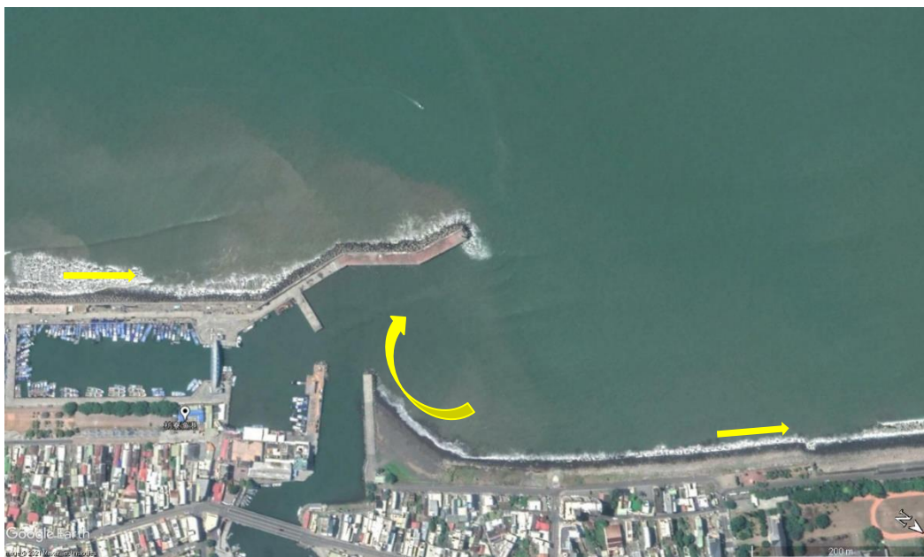
枋寮漁港_Google Earth_細平_半離岸堤_繫岸沙洲_2019_11 優浪. jpg
