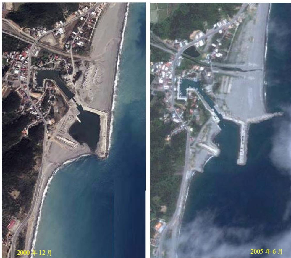
(左)離岸堤效應_mod_大武漁港北側防沙突堤施工前後灘線變遷空照圖_2000年12月_台東海岸(尚武段)監測調查計畫2010；(右)大武漁港北側防沙突堤施工前後灘線變遷空照圖_2005年6月_台東海岸(尚武段)監測調查計畫2010
