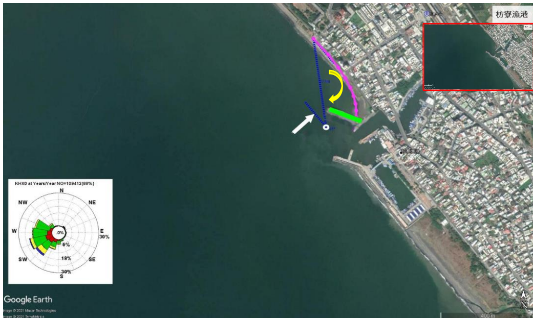
枋寮漁港_Google Earth_小_2019_10 優_岬灣海灘_玫瑰圖_卓越波向繞射點_改善配置. jpg
