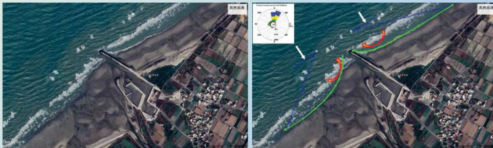
苑裡漁港_Google Earth_細_2018_11優_岬灣海灘_玫瑰圖_卓越波向繞射點.tiff
