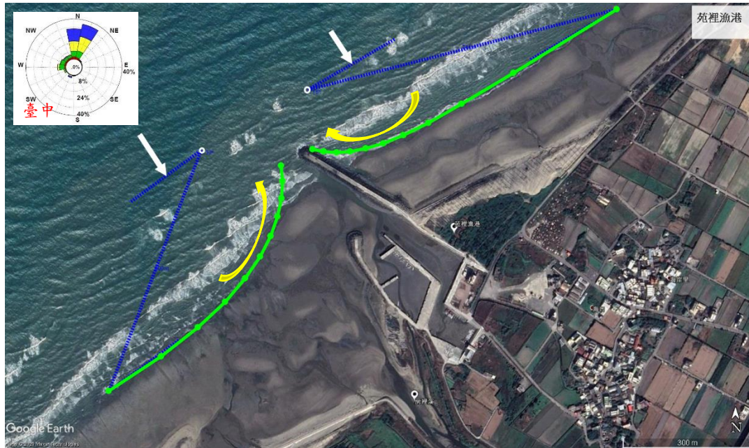
苑裡漁港_Google Earth_細_岬灣海灘_卓越波向繞射點_2018_11.tiff
