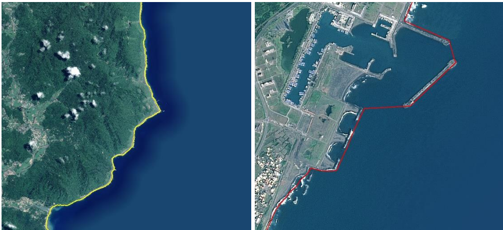
圖 1-5 自然海岸線(左)與人工海岸線(右)套疊之衛星影像
