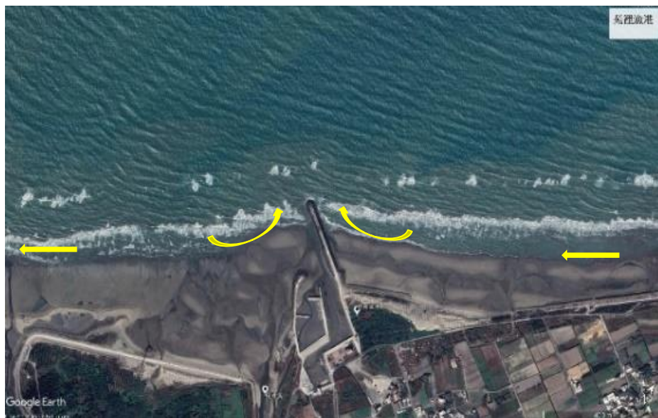
圖 4-79 苗栗苑裡漁港高潮位(上)及低潮位(下)期間港口外廓防波堤兩側因潮間帶內偏正向入射波浪碎波衍生沖刷流作用所造成平直型態之淺灘淤積
