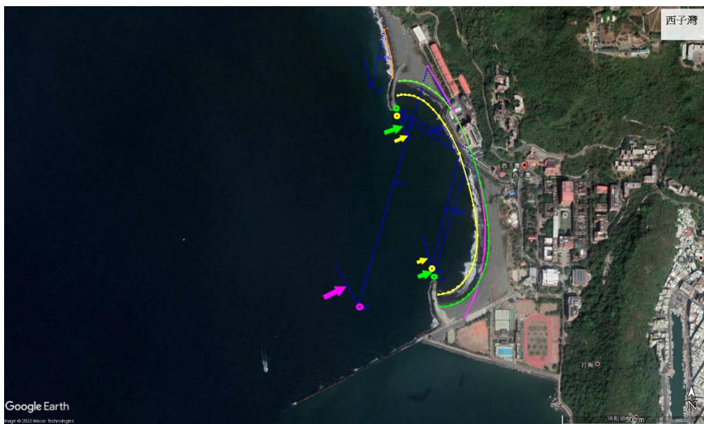
西子灣_人工岬灣_北灘全_北灣_南灣_養灘_卓越波向繞射點_20190118.tif
