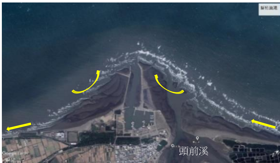
圖 4-76 新竹漁港高潮位(上)及低潮位(下)期間港口外廓防波堤兩側因「離岸堤效應」衍生碎波冲刷環流作用所造成沙舌型型態之淺灘淤積
