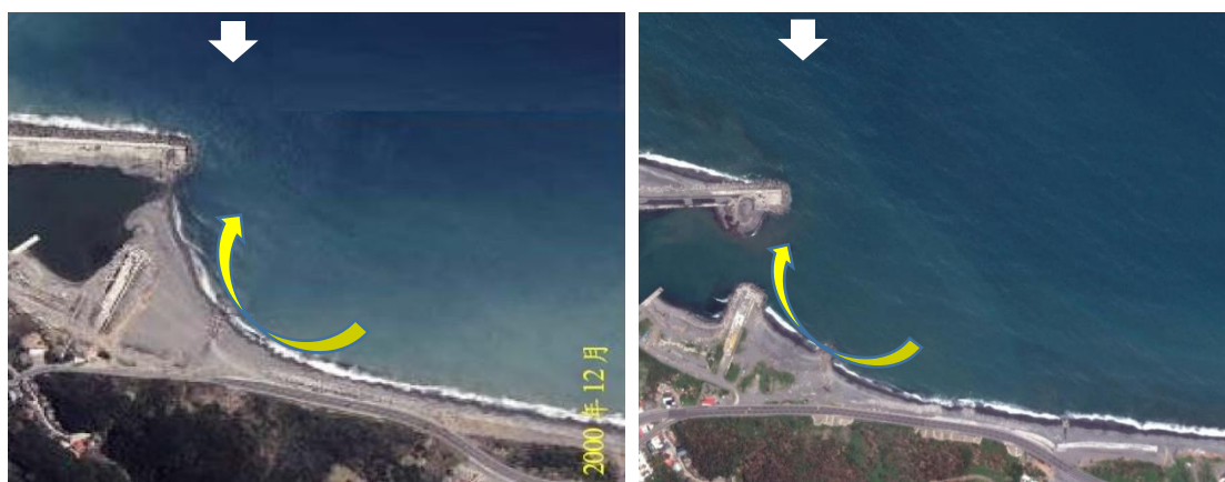
臺灣東部海岸_大武漁港_半離岸堤效應_繫岸沙洲岬灣_200012(左)及 201209(右)
