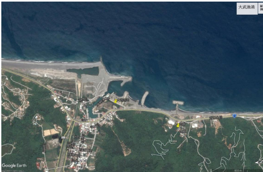
大武漁港_突堤_離岸堤效應 google 地圖 20140702 平小
