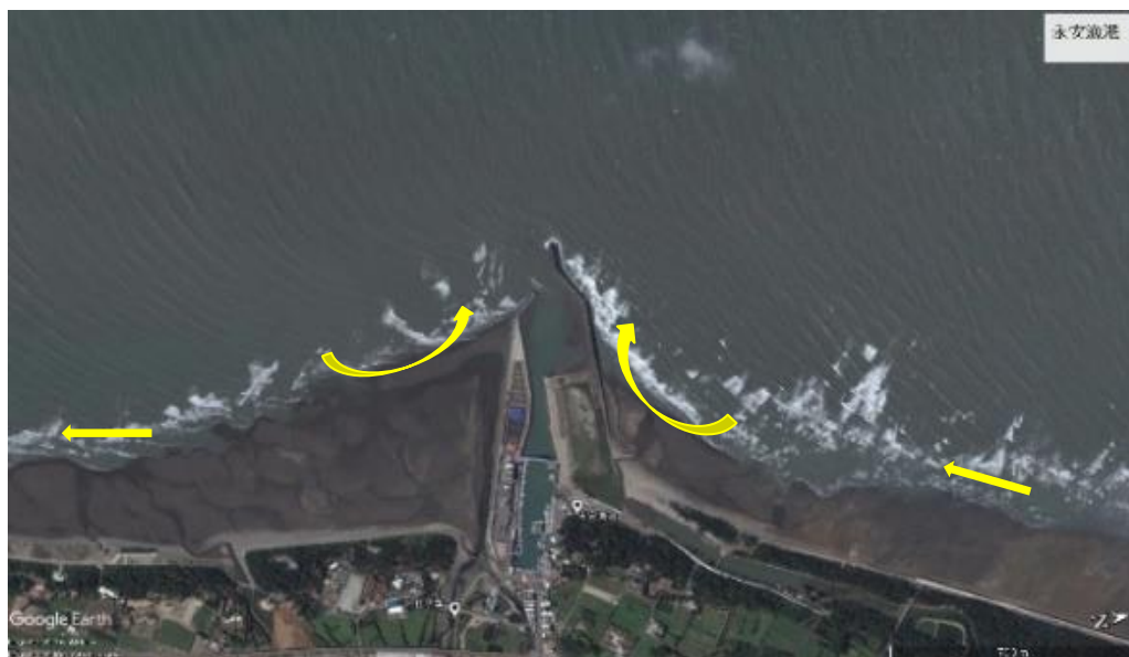
圖 4-75 桃園永安漁港高潮位(上)及低潮位(下)期間港口外廓防波堤兩側因「離岸堤效應」衍生碎波沖刷環流作用所造成沙舌型型態之淺灘淤積
