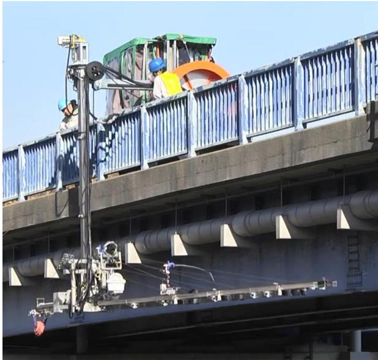
圖 2.24 Zivil 機械手臂型橋梁檢測車實際作業情形（一）
