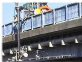
機械手臂型橋梁檢測車
