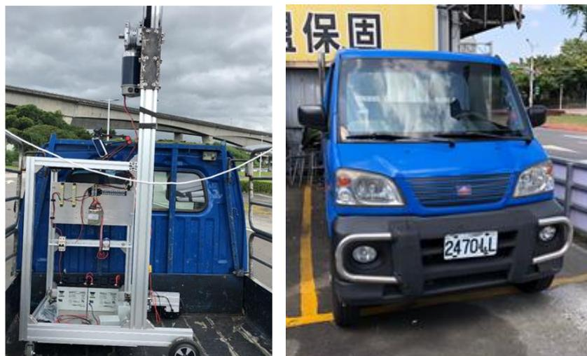
圖 2.57 「推車型橋梁檢測設備」設備搬運照
