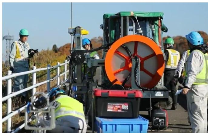
圖 2.16 Zivil 機械手臂型橋梁檢測車組立作業情形
