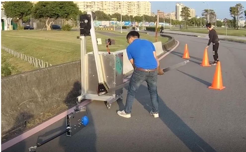
圖 2.62 「推車型橋梁檢測設備」組裝（一）
