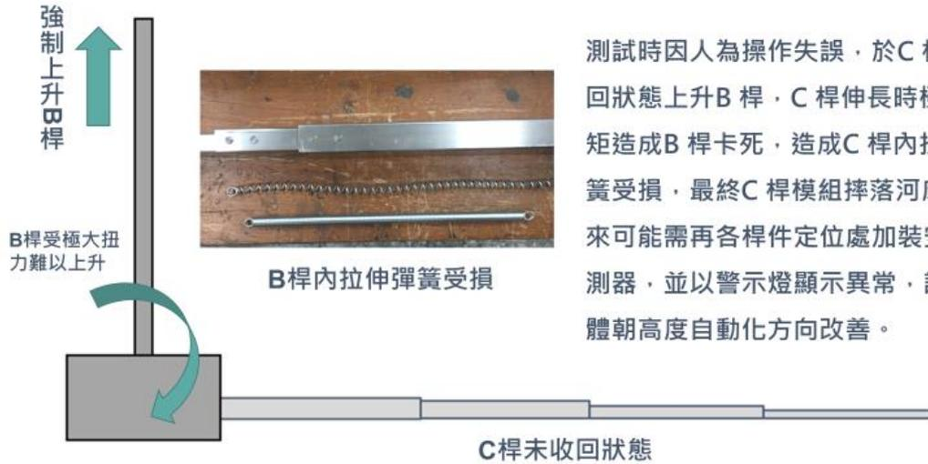
測試時因人為操作失誤，於C桿未收回狀態上升B桿，C桿伸長時極大力矩造成B桿卡死，造成C桿內拉力彈簧受損，最終C桿模組摔落河床。未來可能需再各桿件定位處加裝安全感測器，並以警示燈顯示異常，設備整體朝高度自動化方向改善。
