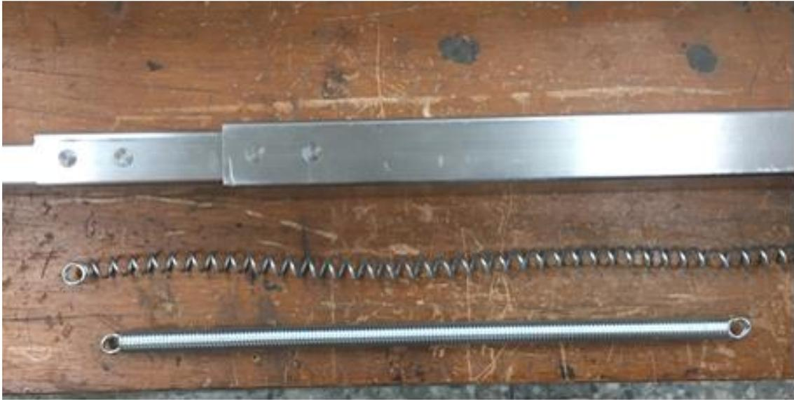
圖 4.17 B 桿內拉力彈簧損壞情形
