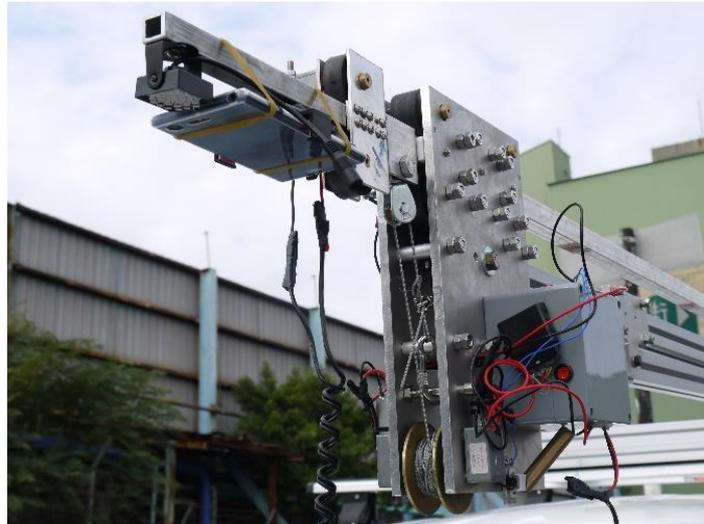
圖 2.50 檢測設備手機及照明架設情形
