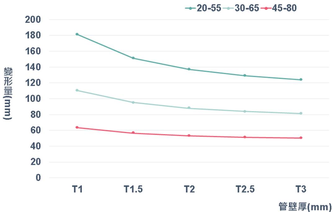
圖 3.5 方形管 C 桿變形量模擬趨勢
