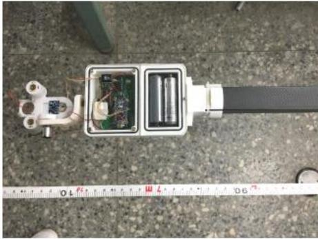
以編碼器控制C桿推送進度，即可控制X軸（沿河川流向）之方向定位，計算馬達轉動圈數，再推算末端裝置移動距離，但驅動裝置存在打滑與推送彈簧線管挫曲問題，且C桿伸長後阻力增加，打滑現象與挫曲時間點難以完全預期並補償。未來若能設法提高定位準確度，即可能達成不需佈標進行影像拼接之功能
