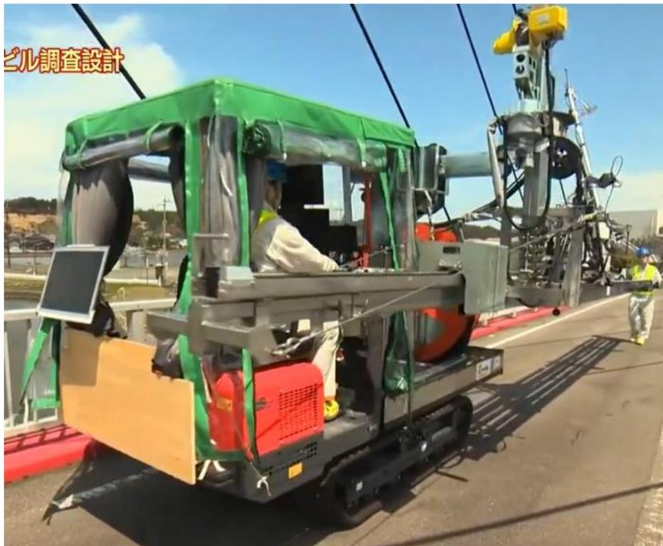
圖 2.11 日本 Zivil 公司機械手臂型橋梁檢測車
