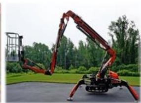
履帶型橋梁檢測車
