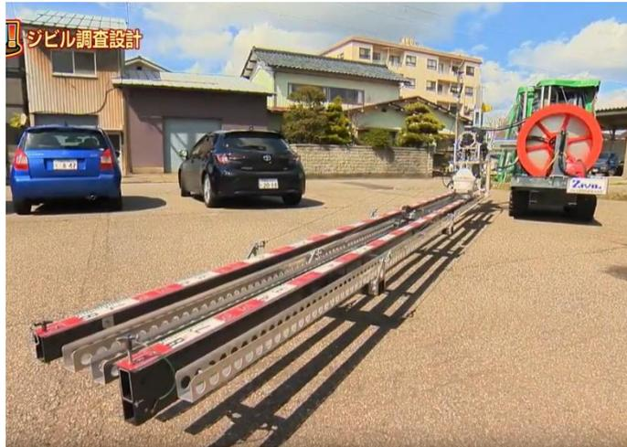
圖 2.14 檢測臂組立後情形
