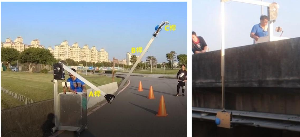
圖 2.53 「推車型橋梁檢測設備」操作情形
