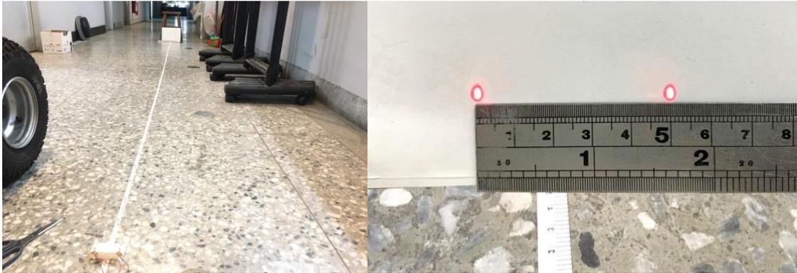
圖3.27 雷射虛擬比例尺模組效果
