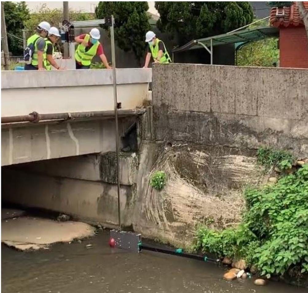
圖 4.18 C 桿摔落河床狀況
