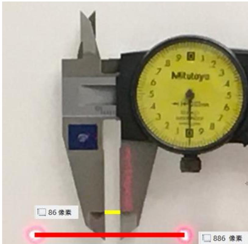
圖3.30 模擬5mm裂縫量測圖
