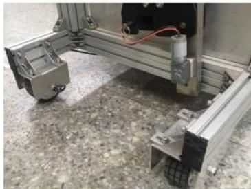
以輪鼓伺服馬達作為設備的驅動輪，並搭配驅動器做控制。馬達為伺服電機自帶編碼器，可應付一定崎嶇路面的移動，驅動器設定參數為每次前進50cm，控制Y軸（沿行車方向）等量前進。於平坦路面上測試，重複誤差約為1cm，已可達影像拼接標準。但於實測時因路況不同，誤差值可能有所不同。
