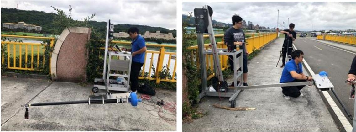
圖 2.61 「推車型橋梁檢測設備」組立完成情形
