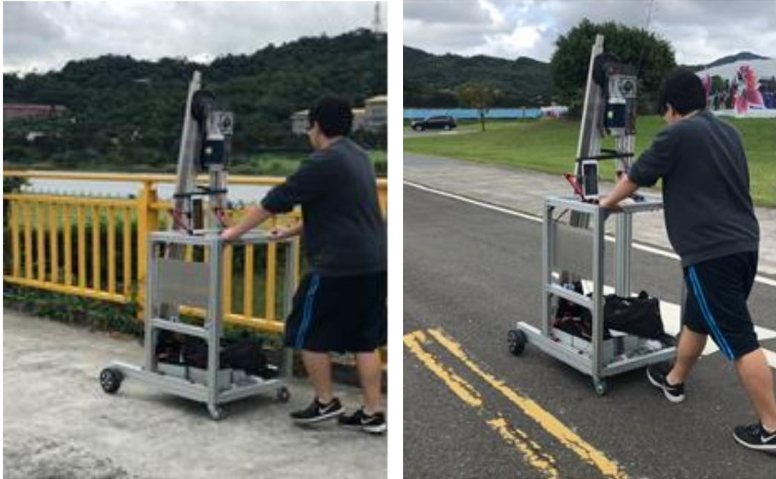
圖 2.58 「推車型橋梁檢測設備」實際推送情形
