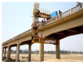
桁架橋梁檢測車
