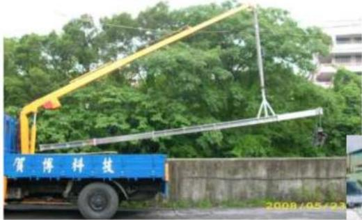
機械手臂型橋梁檢測設備
