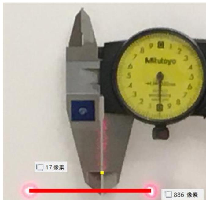
圖3.28 模擬1mm裂縫量測圖
