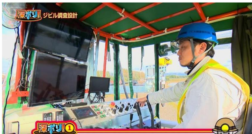
圖 2.26 Zivil 機械手臂型橋梁檢測車控制台作業情形
