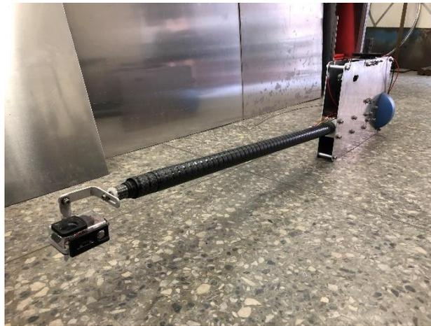
圖 2.56 「推車型橋梁檢測設備」C 桿伸縮實體照
