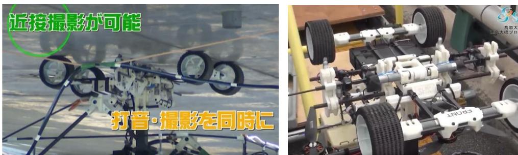
圖 2.33 具敲擊測試及攝影功能之 UAV
