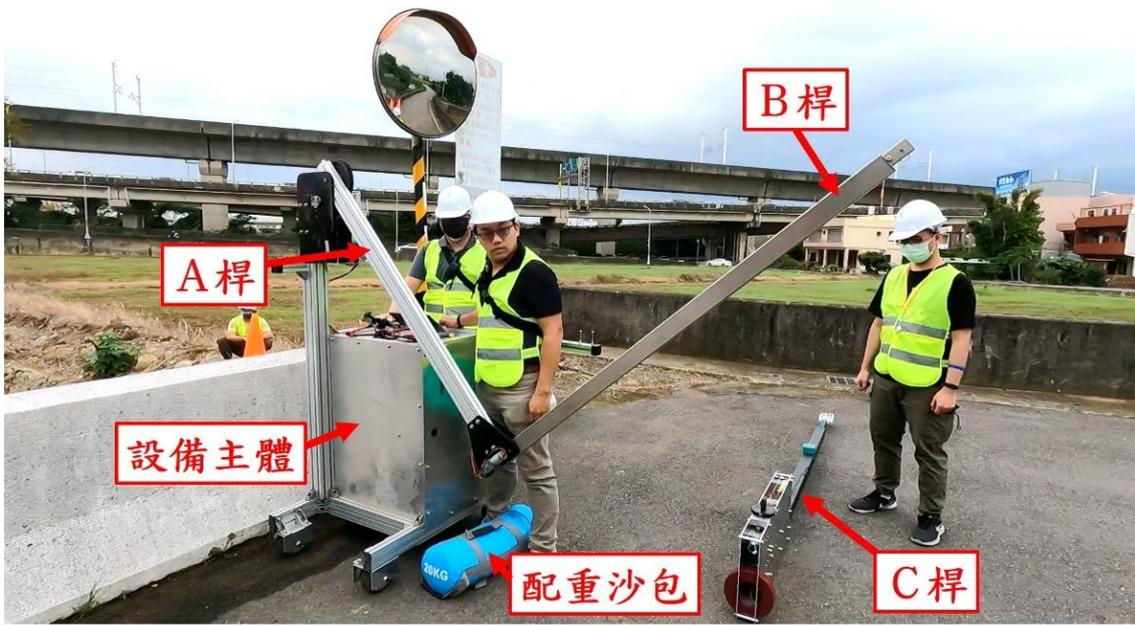
圖3.45 設備整體分解圖
