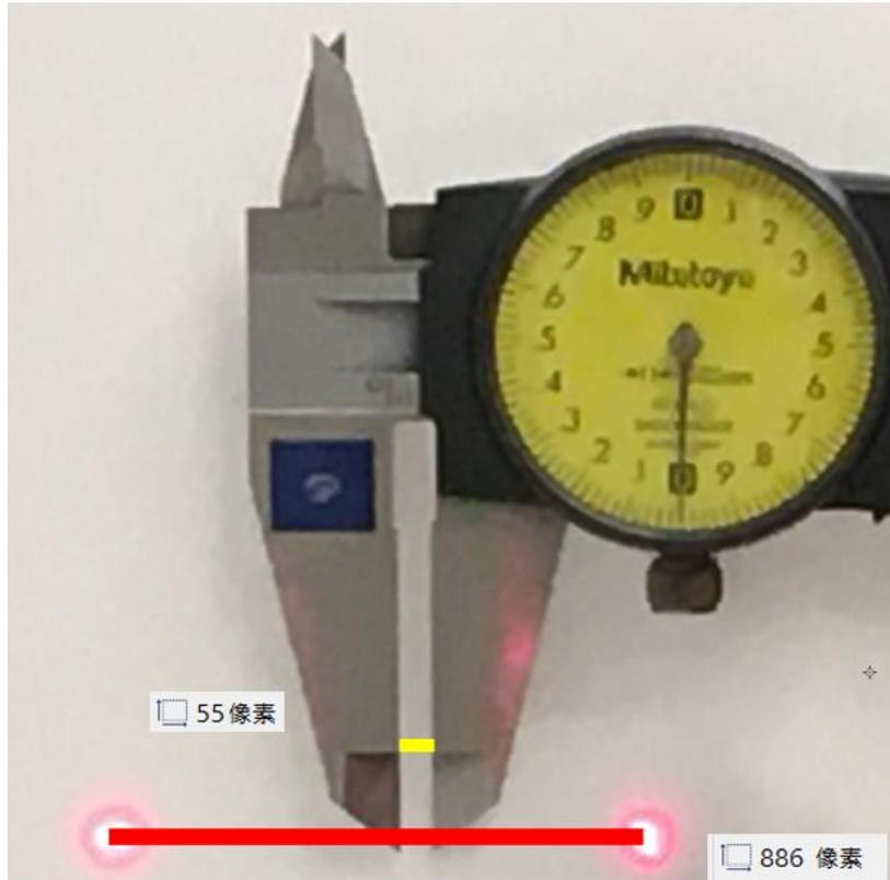
圖3.29 模擬3mm裂縫量測圖
