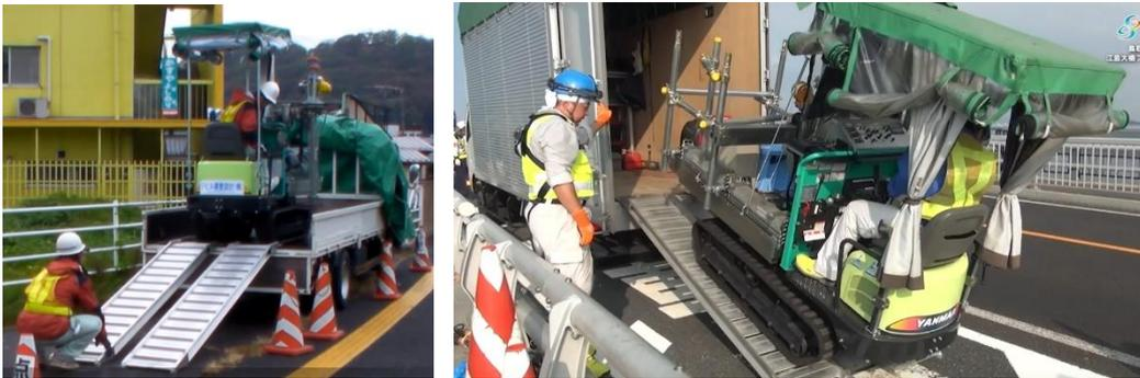
圖 2.12 Zivil 機械手臂型橋梁檢測車載送方式
