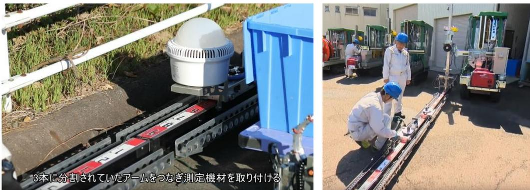
圖 2.13 檢測臂組立作業情形
