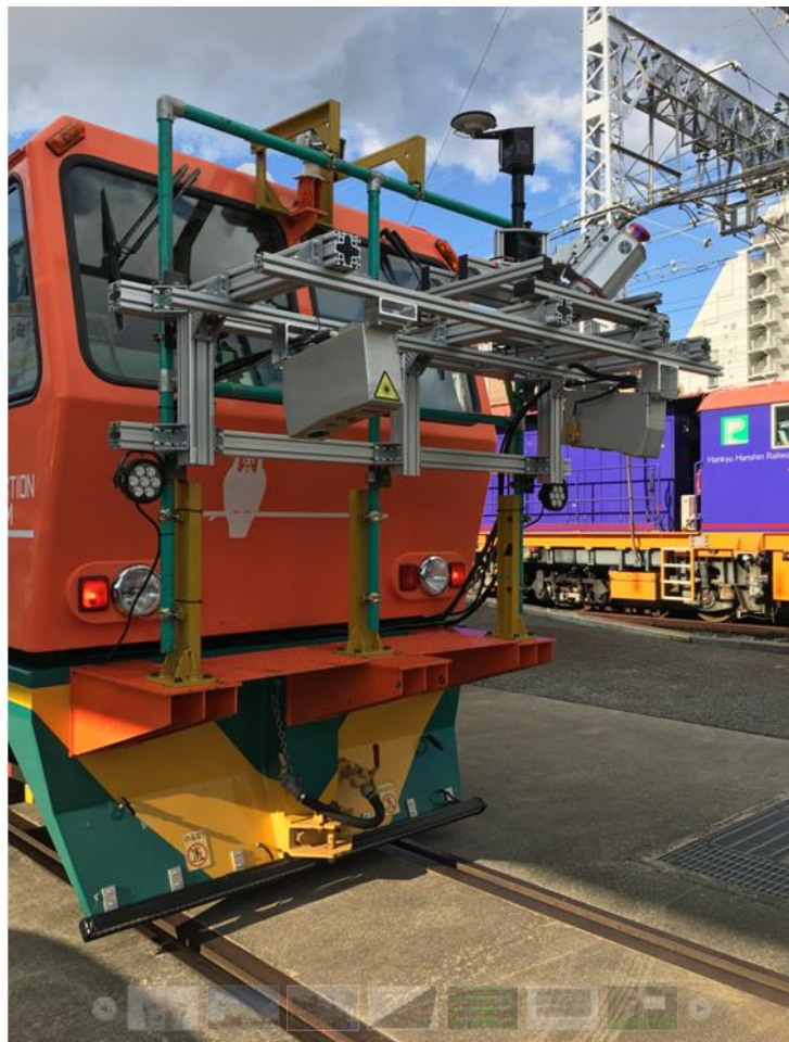
圖 2.4 LRAIL 架設方式（二） [19]
