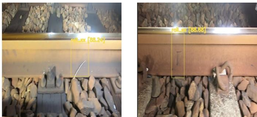
(a)金屬銀色很像剛裂開之鋼軌裂縫 (b)不明記號就像黑奇異筆
