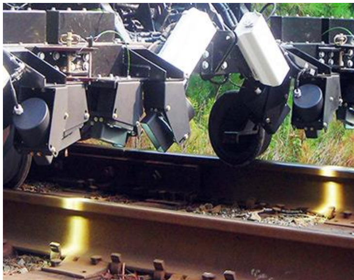
(b) 鋼軌接縫檢測(魚尾鉗側視攝影)
