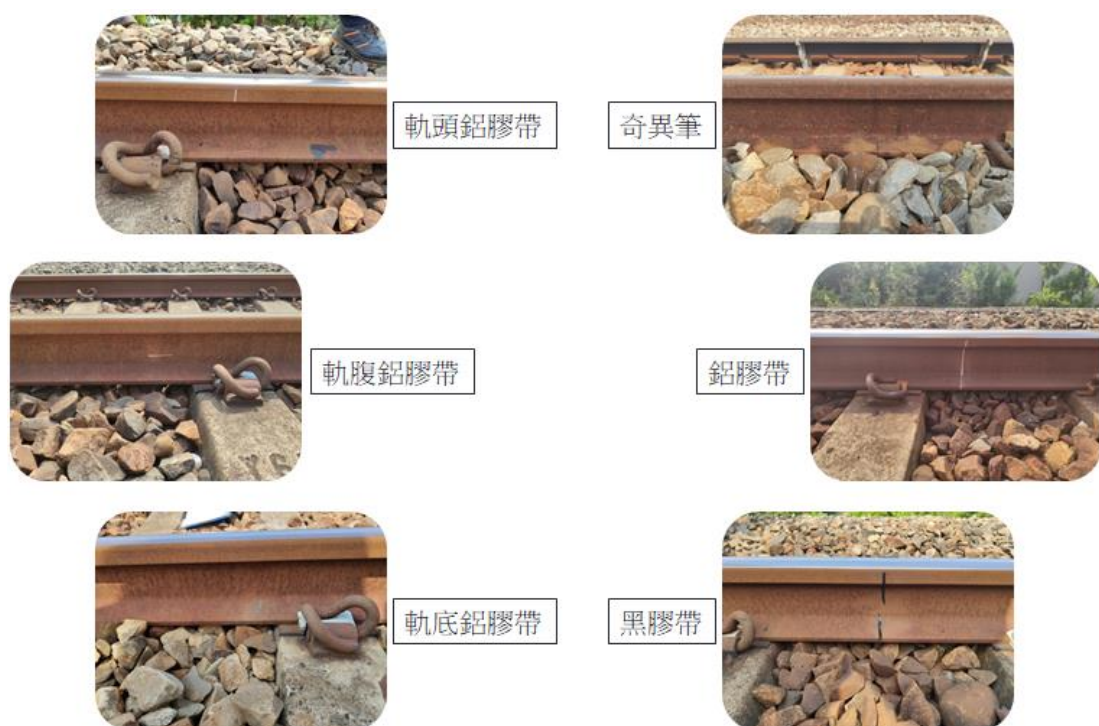
圖 4.18 人工製作側視缺失構件方式
