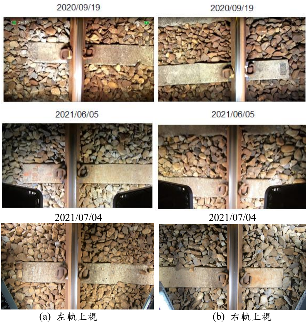
圖 4.9 第三代平車 v3 版之上視軌道構件攝影結果
