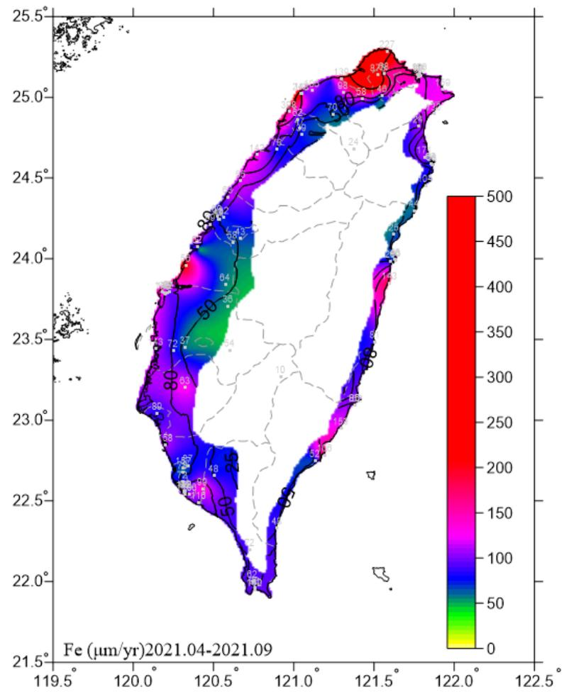
圖 6.10 2021.04-2021.09 碳鋼腐蝕速率圖
