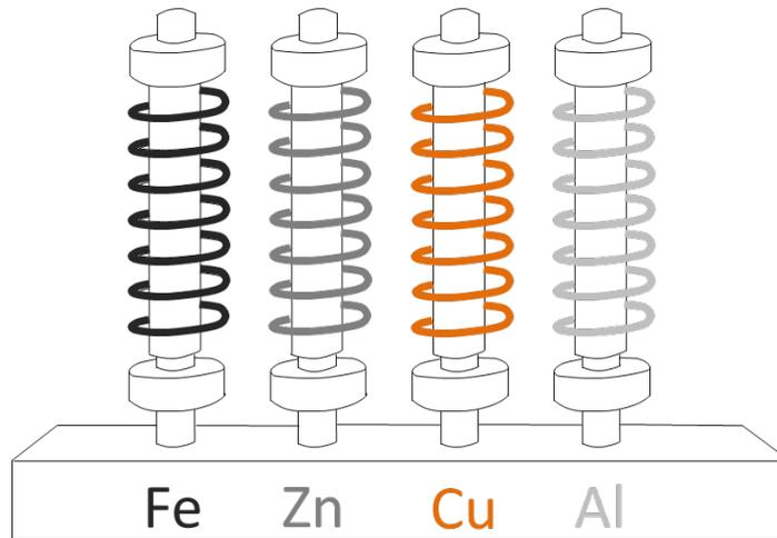
圖 1.5 金屬線材試樣曝放裝置圖
