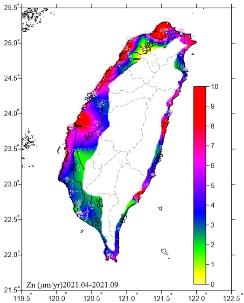
圖 6.13 2021.04-2021.09 鋅腐蝕速率圖
