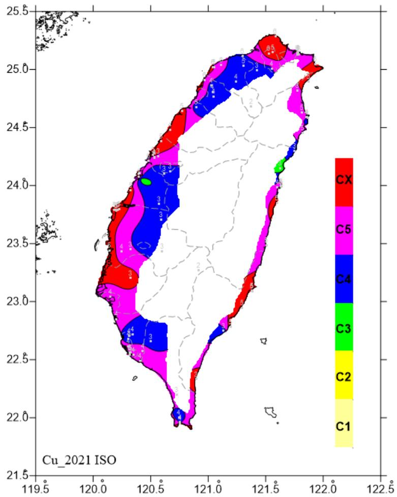
圖 6.27 2021 年銅年腐蝕速率 ISO 分類圖
