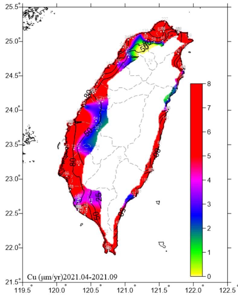
圖 6.16 2021.04-2021.09 銅腐蝕速率圖
