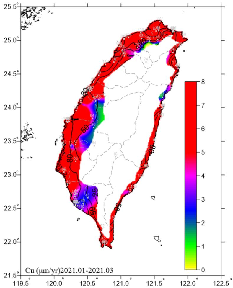
圖 6.15 2021.01-2021.03 銅腐蝕速率圖
