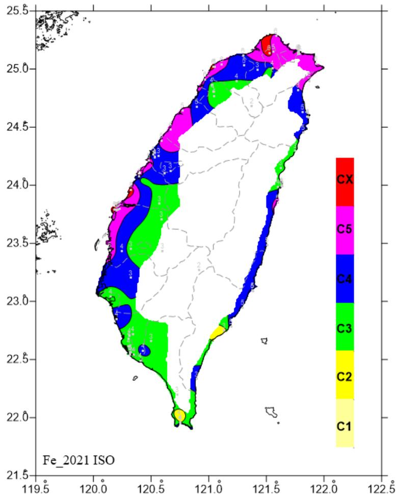
圖 6.25 2021 年碳鋼年腐蝕速率 ISO 分類
