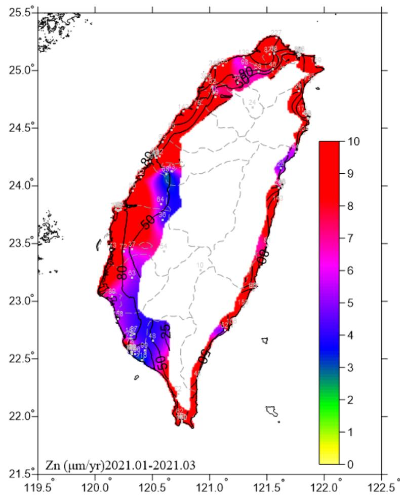
圖 6.12 2021.01-2021.03 鋅腐蝕速率圖
