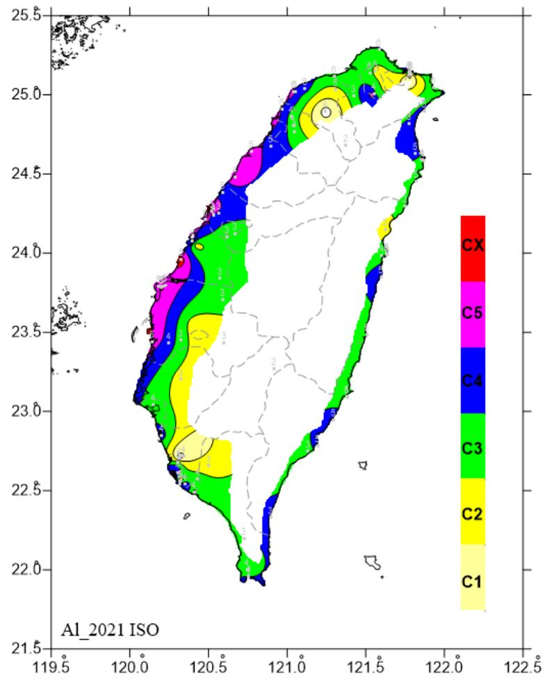
圖 6.28 2021 年鋁年腐蝕速率 ISO 分類圖
