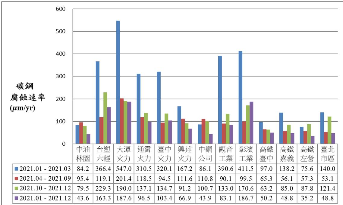
註 1: 台塑六輕、大潭火力腐蝕速率為測站平均值
