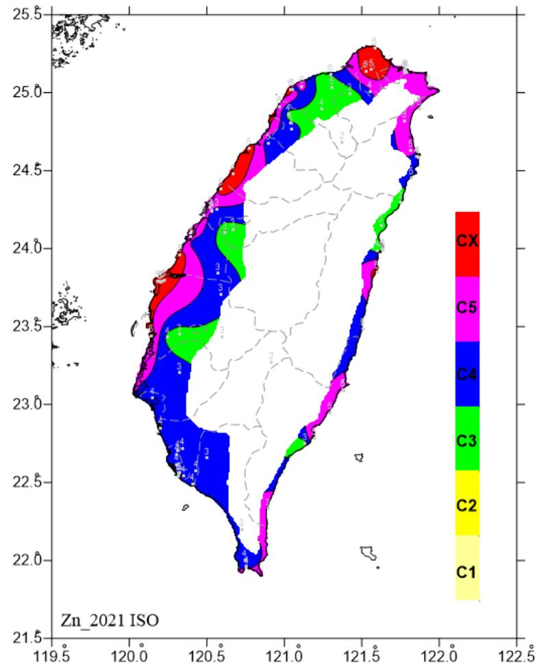
圖 6.26 2021 年鋅年腐蝕速率 ISO 分類圖
