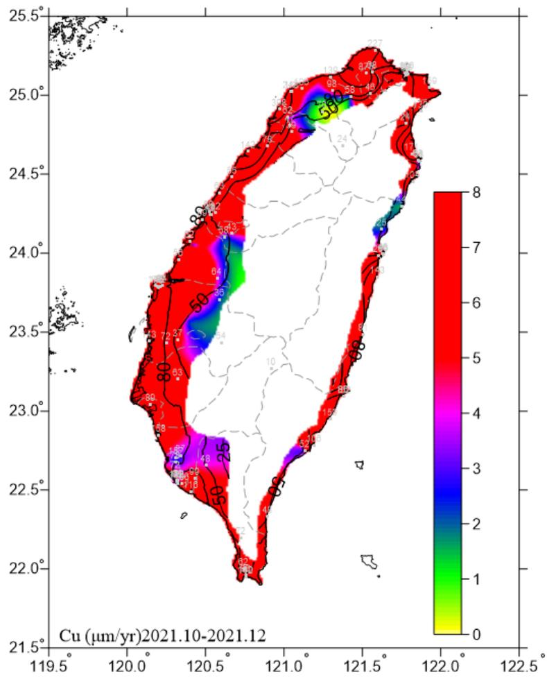
圖 6.17 2021.10-2021.12 銅腐蝕速率圖
