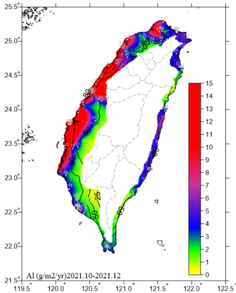
圖 6.20 2021.10-2021.12 鋁腐蝕速率圖
