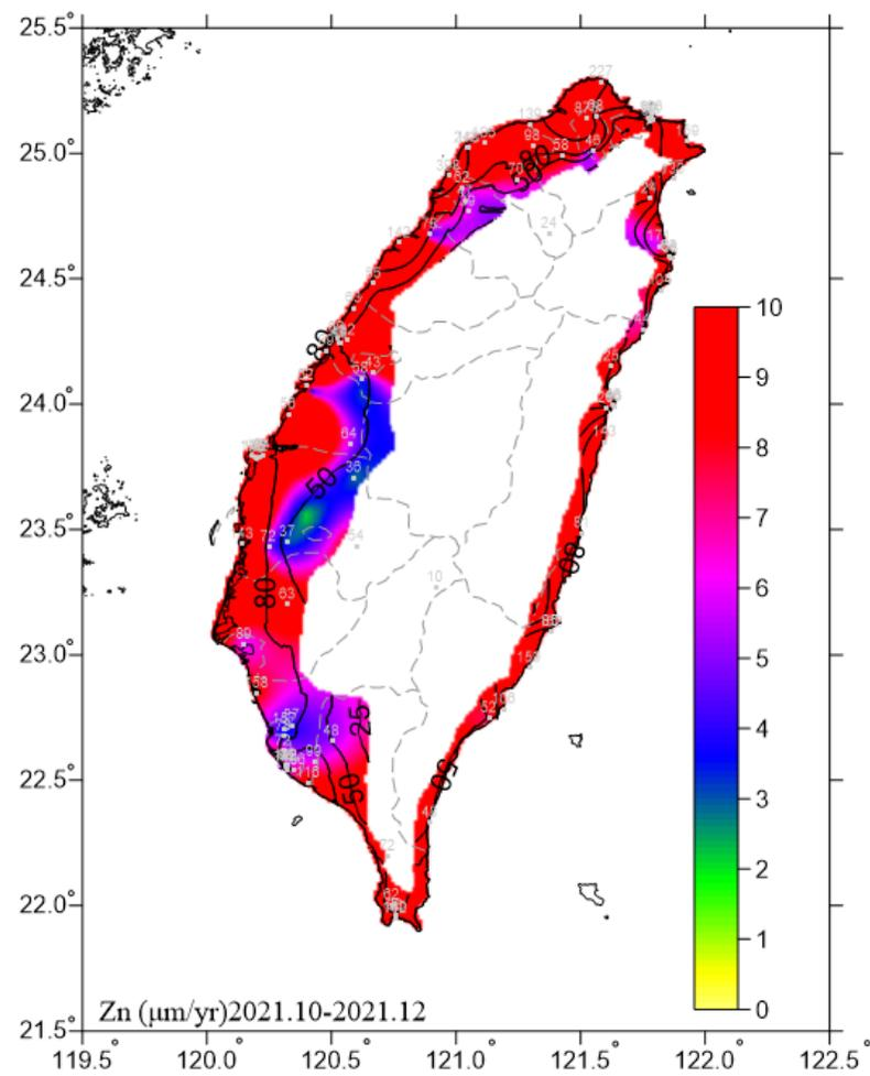
圖 6.14 2021.10-2021.12 鋅腐蝕速率圖
