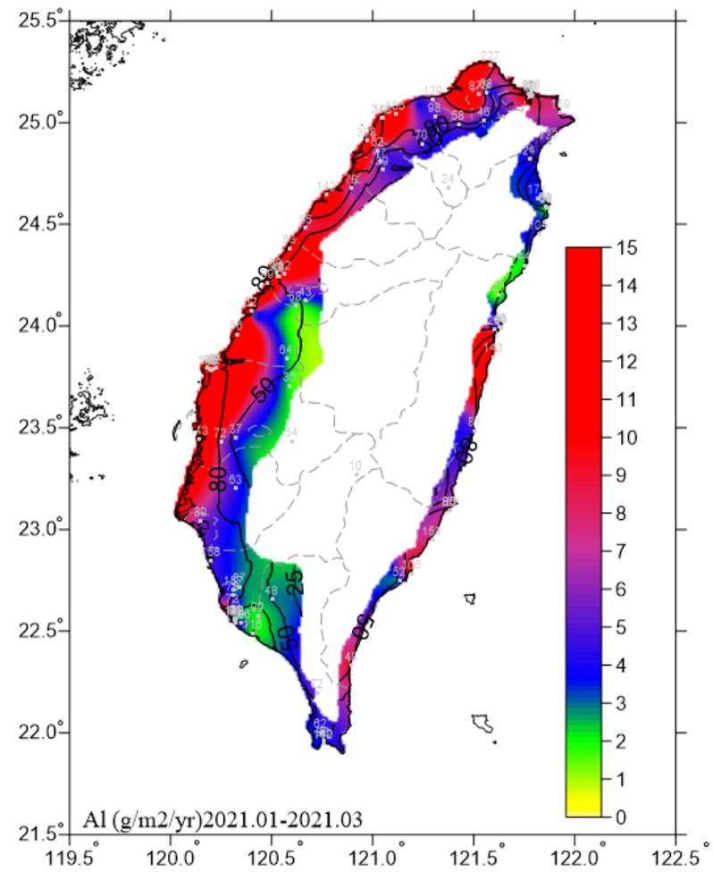
圖 6.18 2021.01-2021.03 鋁腐蝕速率圖
