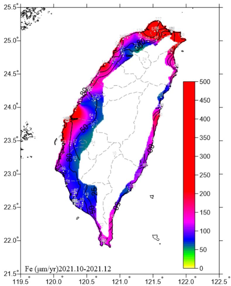
圖 6.11 2021.10-2021.12 碳鋼腐蝕速率圖
