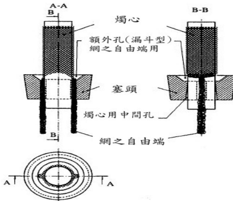
圖 1.1 濕燭法燭心構造示意圖
