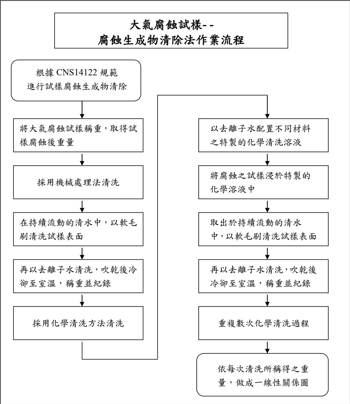
圖 1.6 腐蝕生成物清除法作業流程
