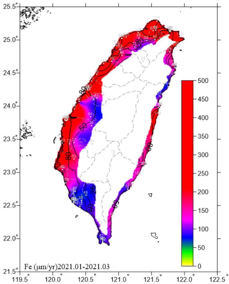
圖 6.9 2021.01-2021.03 碳鋼腐蝕速率圖
