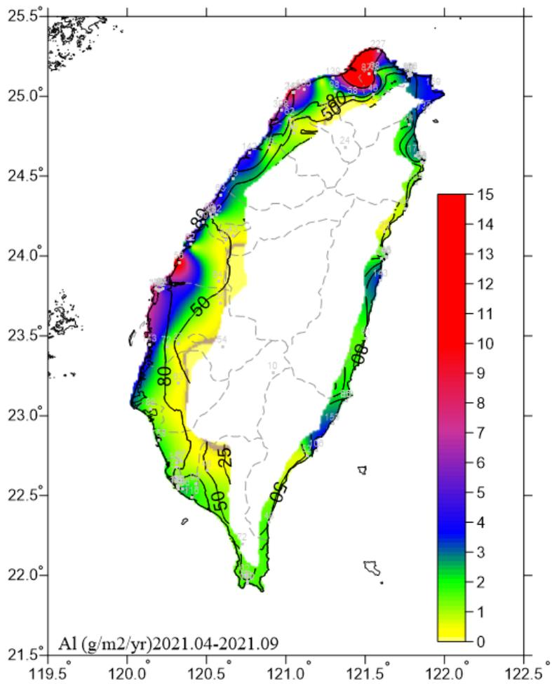
圖 6.19 2021.04-2021.09 鋁腐蝕速率圖
