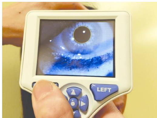
圖 12 電子瞳孔機熒幕<sup>14</sup>
