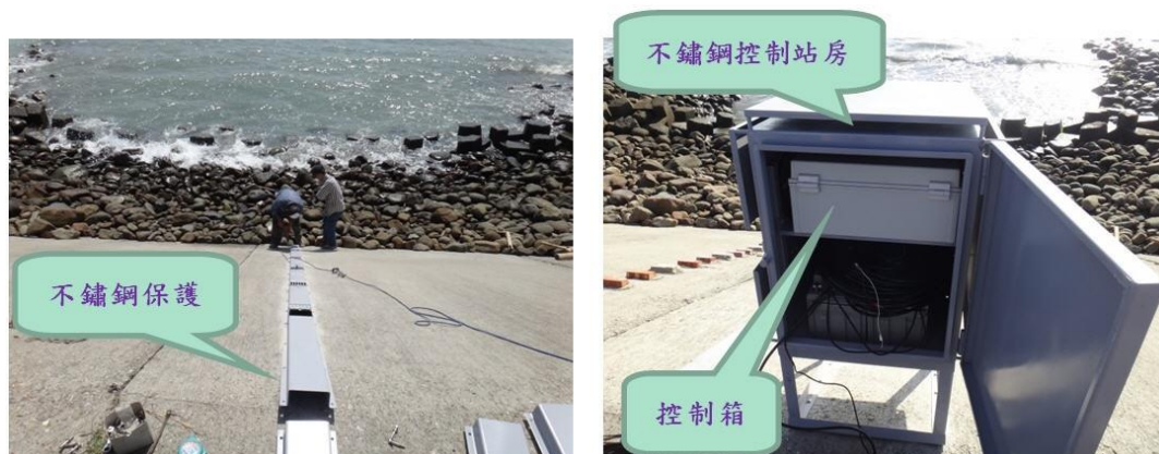
圖 2.14 水利署能專計畫(2013~2014 年)於臺南市七股區曾文海埔地海堤堤面上架設溯升觀測站
