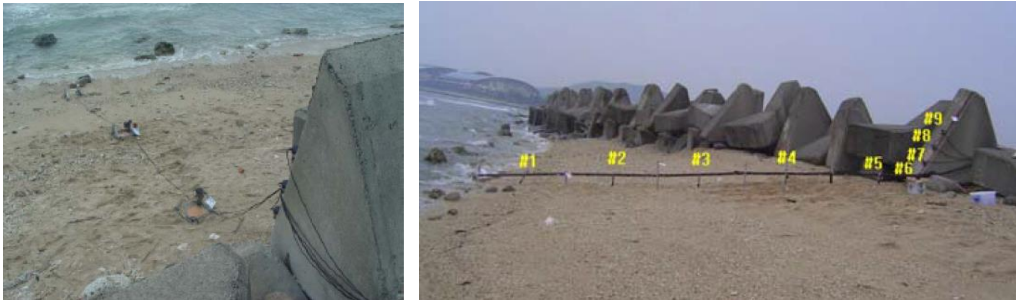
圖 2.13 第七河川局委託計畫(2006~2008 年)於屏東縣車城鄉後灣海岸灘面及消波塊上架設溯升觀測站
