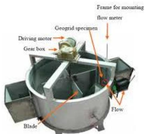
圖 2.6 直徑 1.5 m 高 1.0 m 之圓形流槽
