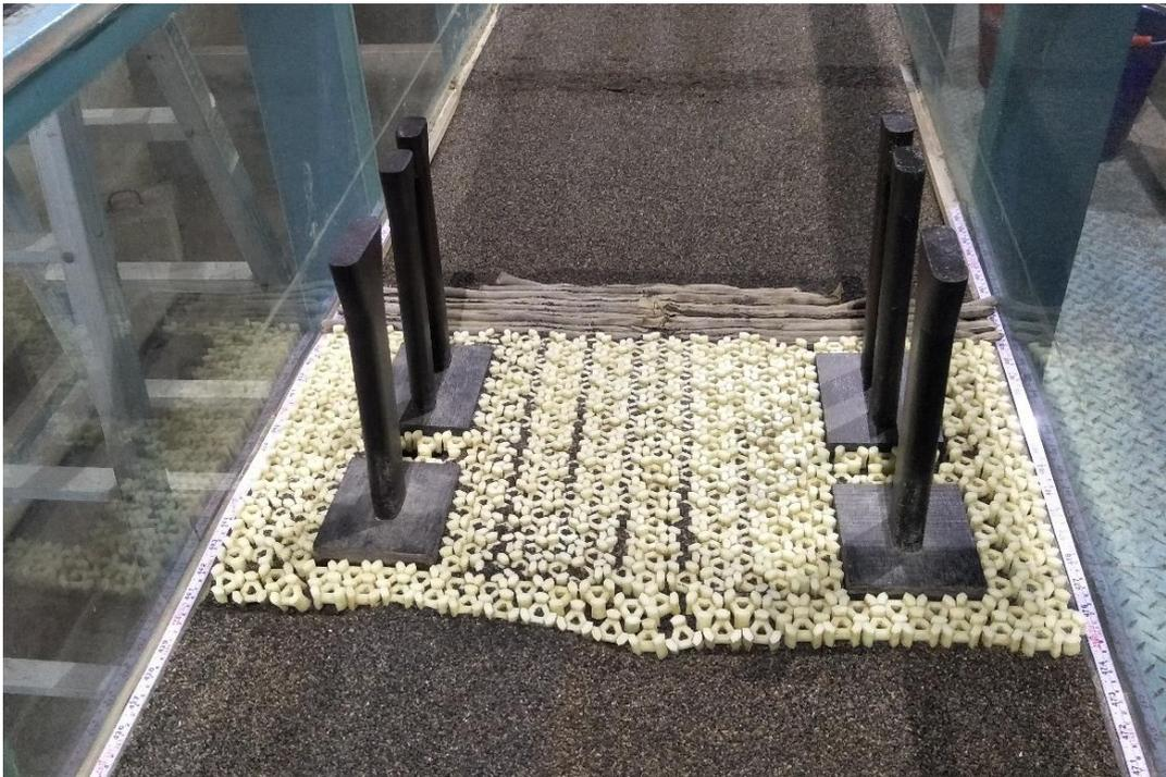
圖 2.25 一層鼎型塊+織布+石籠沖刷情形
