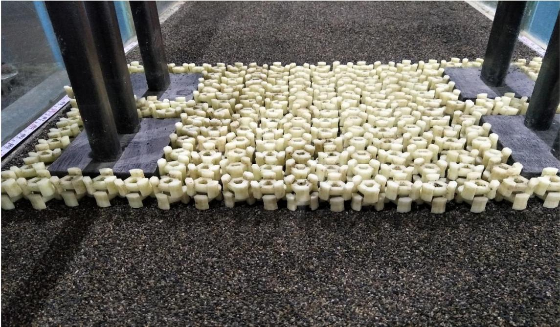
圖 2.14 現況保護措施模型鋪設
