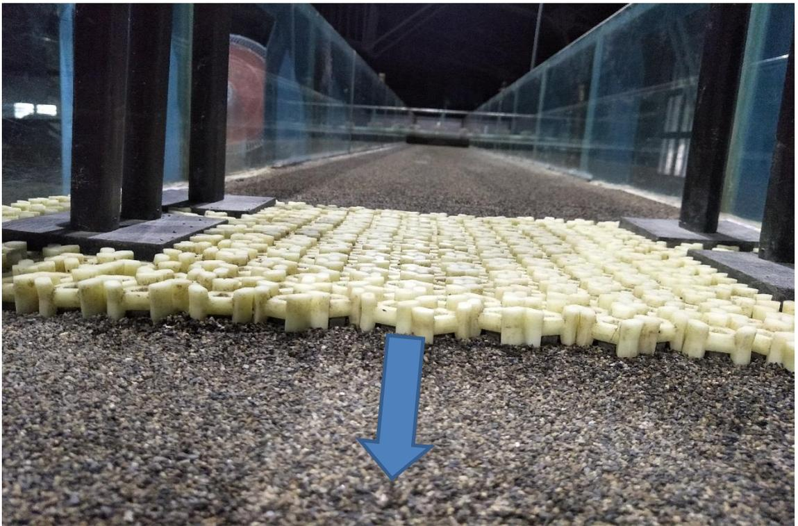
圖 2.21 一層鼎型塊+織布保護措施模型鋪設
