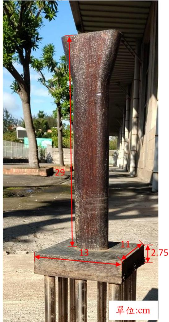
圖 4.8 試驗橋墩模型照片
