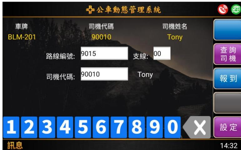
圖 5.11(a) 車載機程式的主要操作畫面-報到畫面
