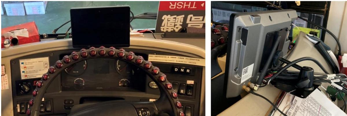
圖 5.9 本計畫所開發的車載機試安裝於公車上的照片
