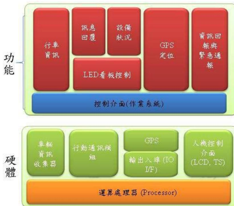
圖 5.4 營業大客車車載機系統架構圖[50]
