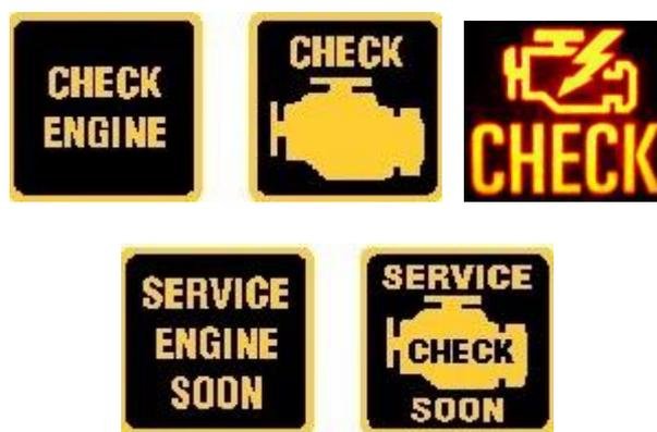
圖 1 各類引擎故障與檢查引擎燈號圖示
