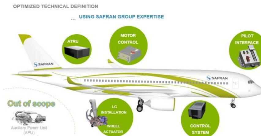
圖 4-12 Safran 電動滑行系統配備
