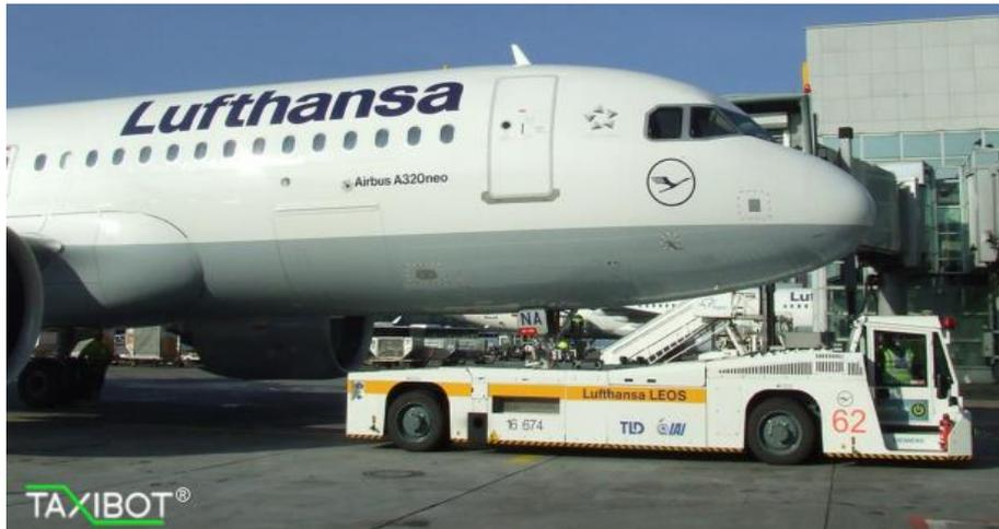
圖 4-14 航機由 TaxiBot 拖車帶動滑行
