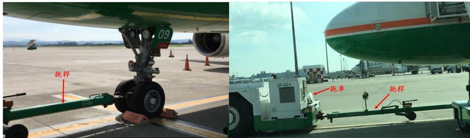
圖 4-2 拖車拖桿接妥於航機鼻輪
