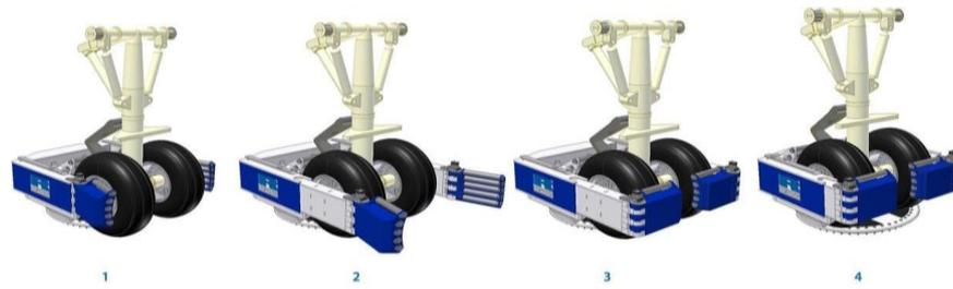
圖 4-16 TaxiBot 拖車扣住航機鼻輪
