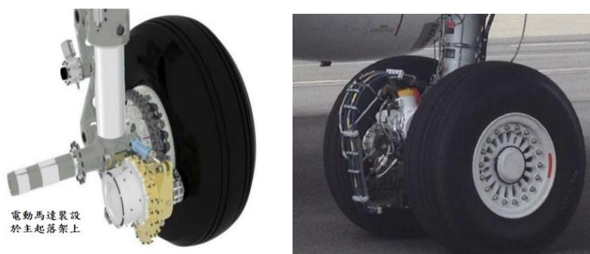
圖 4-11 Safran 電動滑行系統(主起落架)
