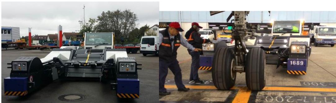
圖 4-3 無拖桿地勤拖車(左)以機器手臂夾住鼻輪(右)
