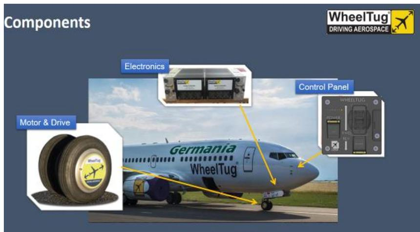
圖 4-9 WheelTug 電動滑行之系統配備圖示
