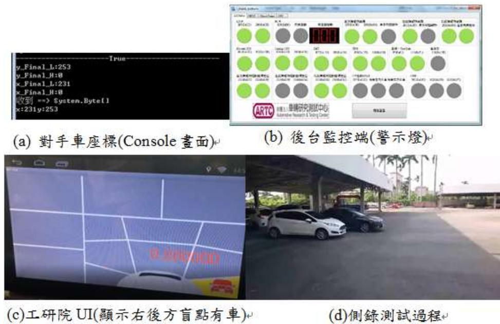
圖 4.8.42 BSD 系統進行右後方盲點來車測試
