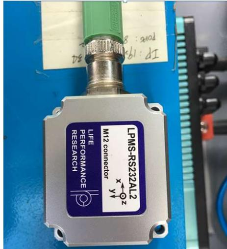
圖 3.4.1-7 慣性測量單元安裝示意圖
