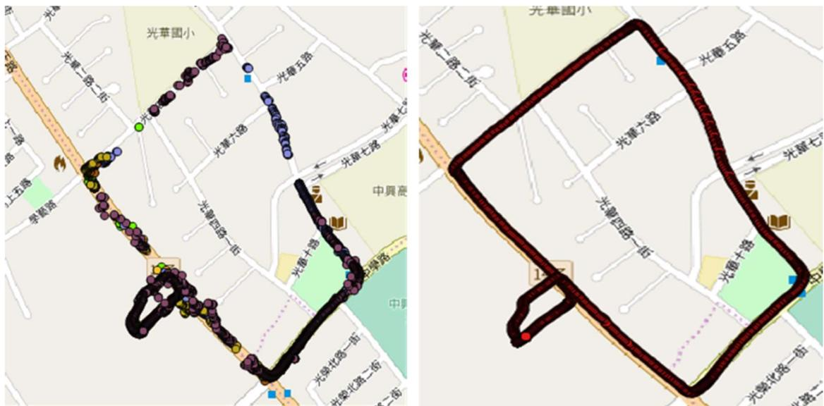
圖 3.4.2-6 利用 RTK-GPS、DGPS、Garmin 定位分析
