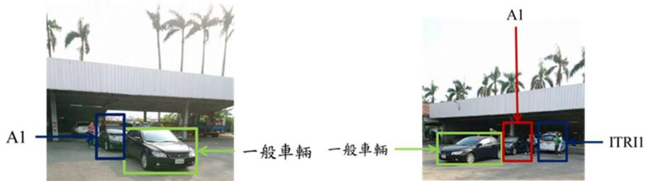
圖 3.4.2-1 前方/側後方 ADAS 系統功能測試與實車測試配置圖
