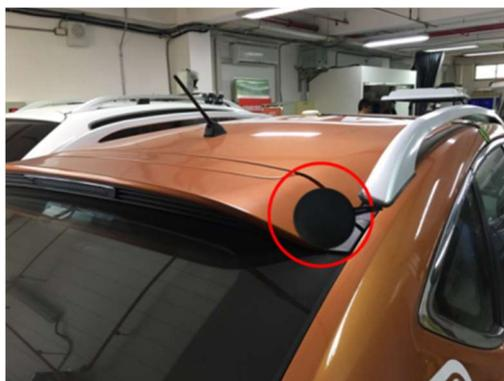
圖 3.4.1-13 ADAS 車輛 GNSS 天線安裝示意圖
