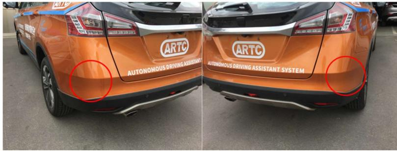
圖 3.4.1-12 ADAS 車輛後方 Radar 安裝示意圖
