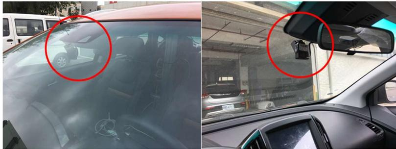
圖 3.4.1-10 ADAS 車輛 Camera 安裝示意圖
