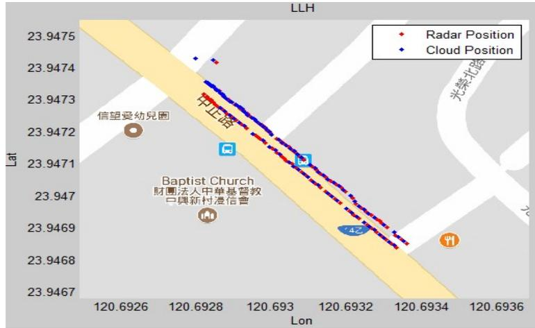
圖 4.7.59 Test9 雷達/DGPS 軌跡與圖資疊合
