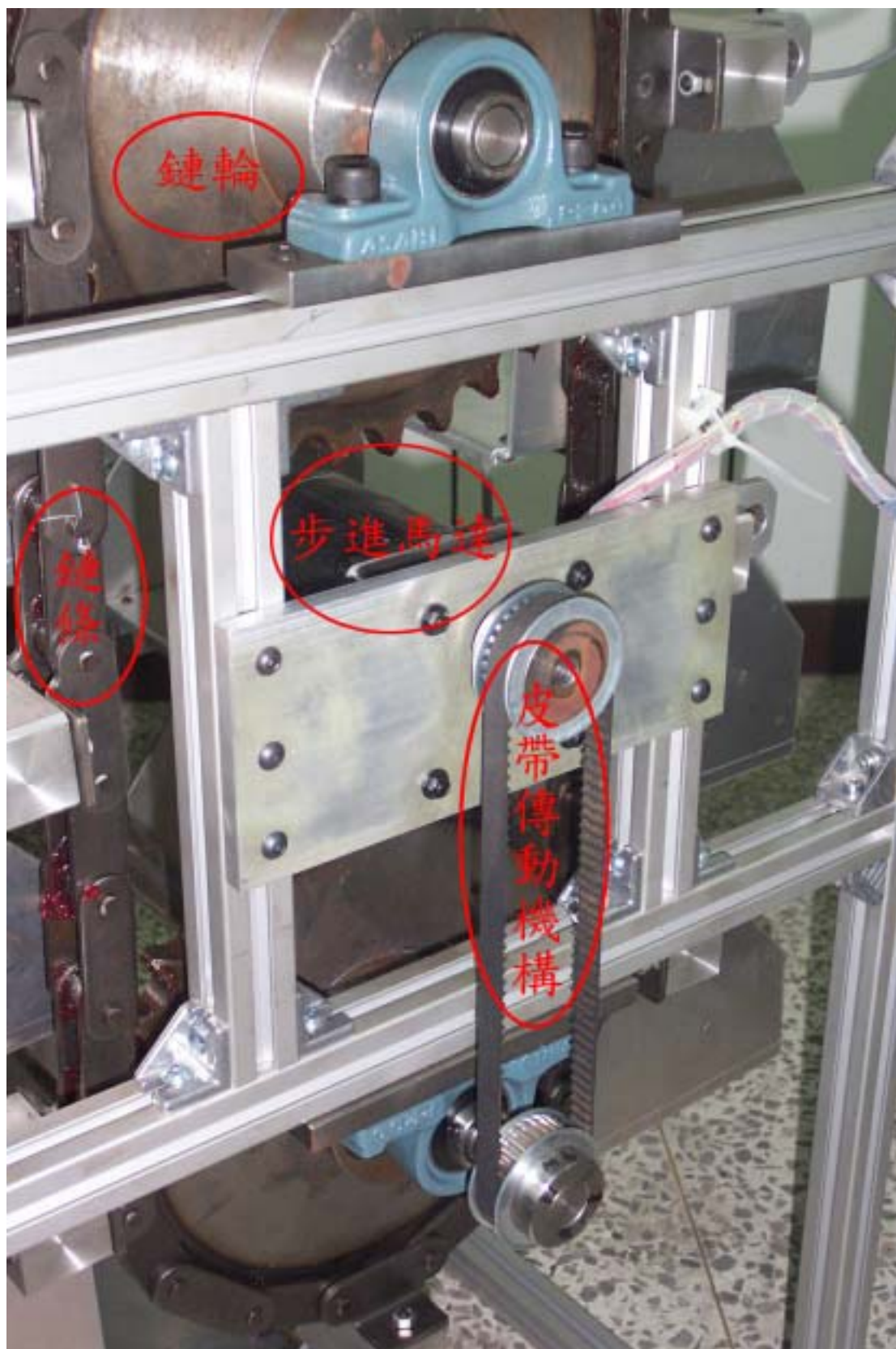
圖 5-10 動力傳動機構
