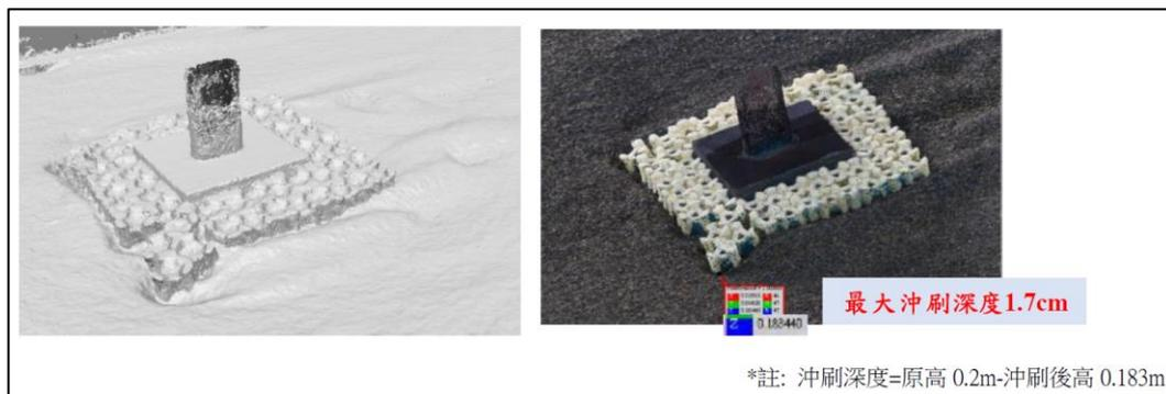
圖 32 方形基礎+鼎型塊保護工水槽試驗結果
