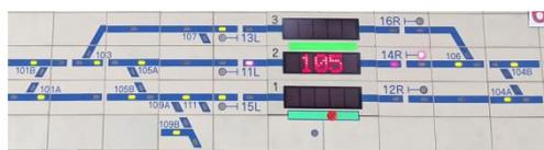
圖 4.7 臺南站行控中心面板照片
