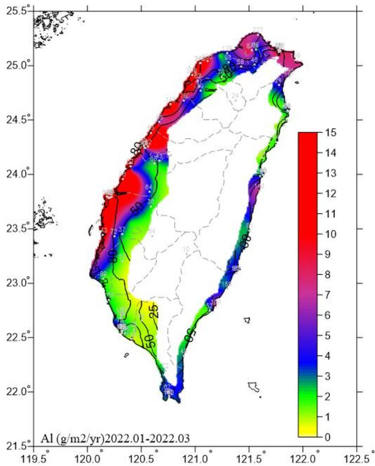
圖 6.21 2022.01-2022.03 鋁腐蝕速率圖
