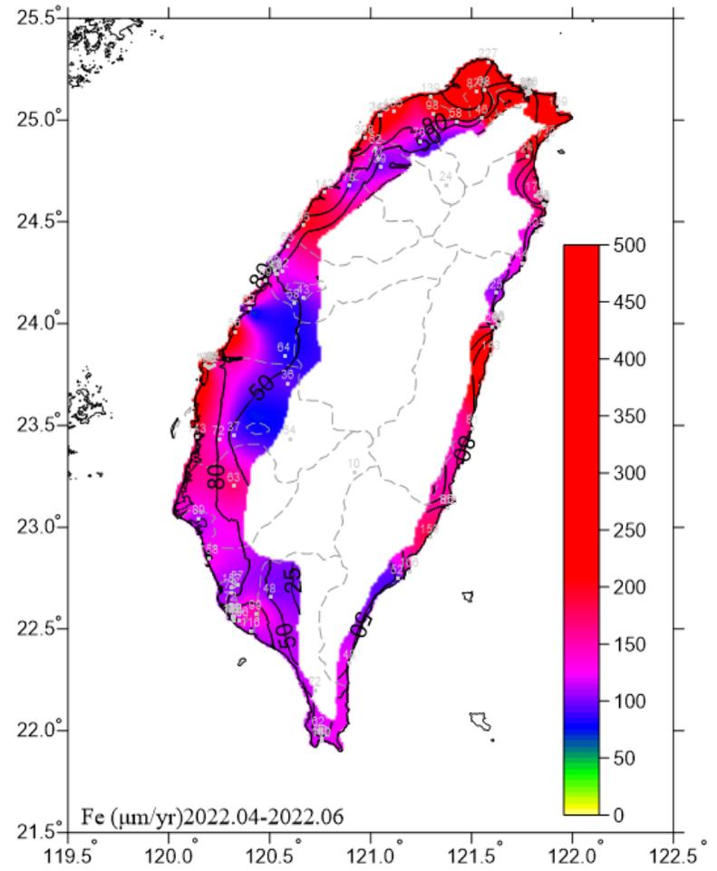
圖 6.10 2022.04-2022.06 碳鋼腐蝕速率圖
