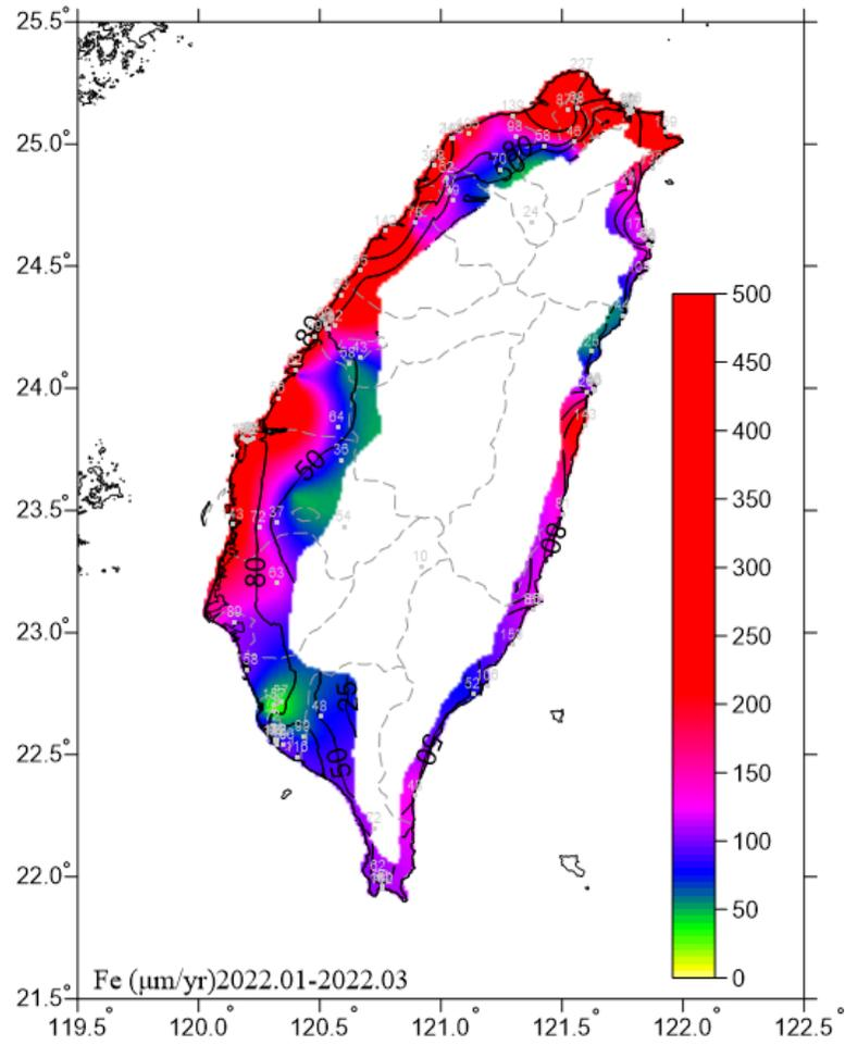
圖 6.9 2022.01-2022.03 碳鋼腐蝕速率圖
