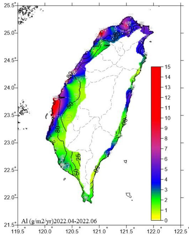
圖 6.22 2022.04-2022.06 鋁腐蝕速率圖
