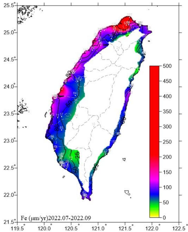
圖 6.11 2022.07-2022.09 碳鋼腐蝕速率圖
