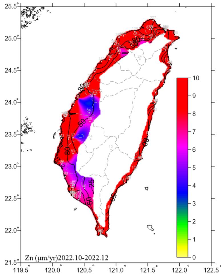
圖 6.16 2022.10-2022.12 鋅腐蝕速率圖
