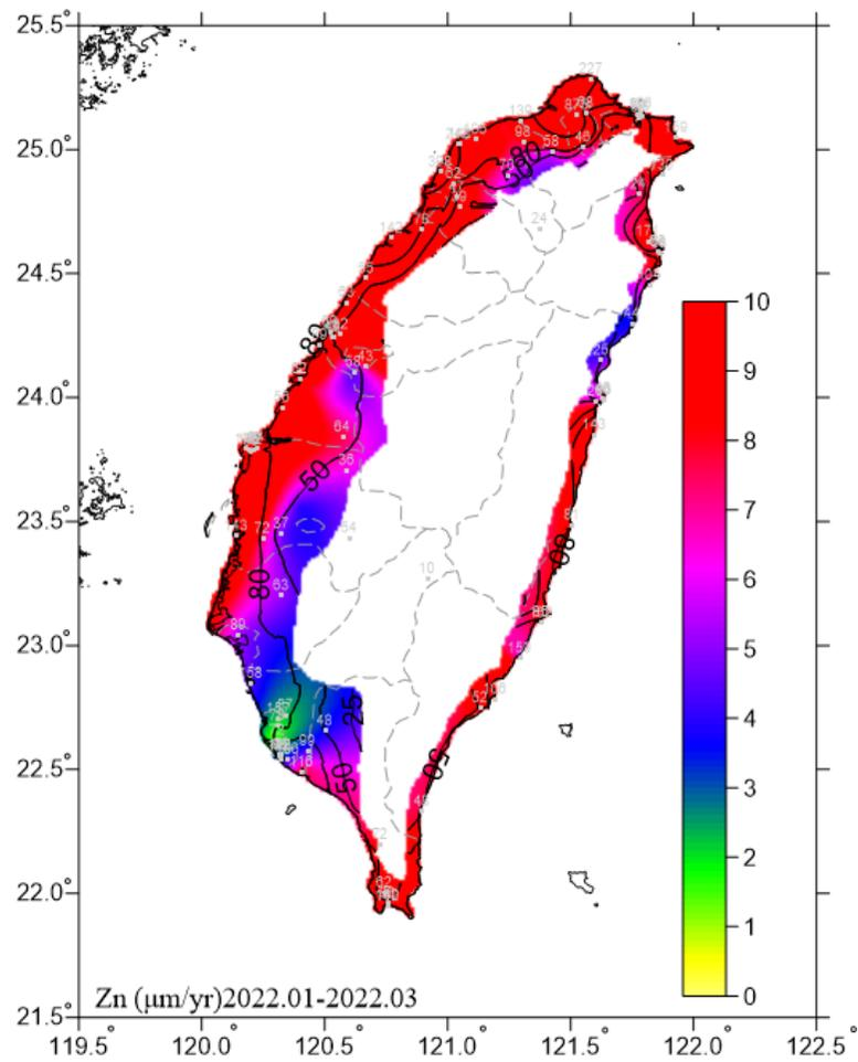
圖 6.13 2022.01-2022.03 鋅腐蝕速率圖
