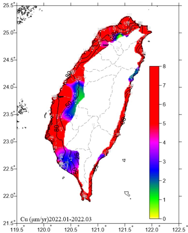
圖 6.17 2022.01-2022.03 銅腐蝕速率圖
