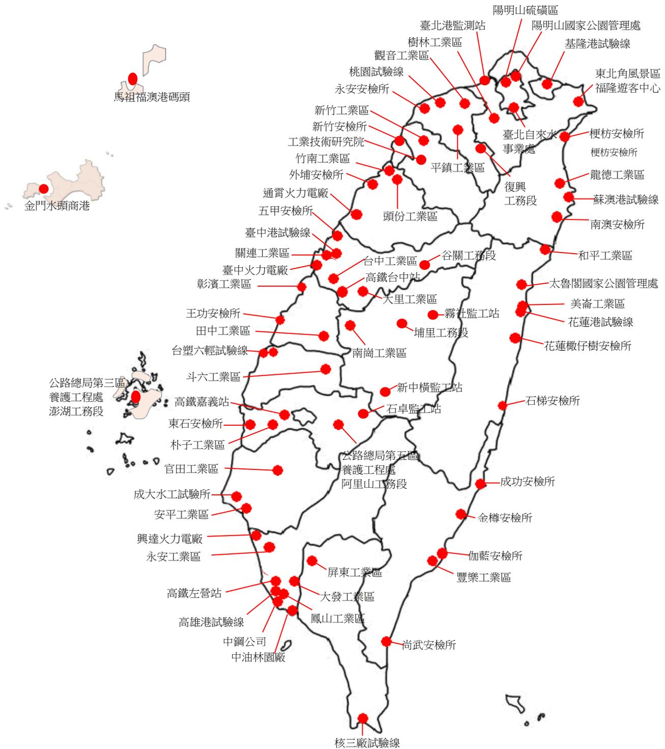
圖 2.3 金屬曝露試驗(碳鋼、鋅、銅、鋁)點分佈圖
