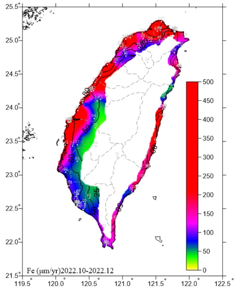
圖 6.12 2022.10-2022.12 碳鋼腐蝕速率圖
