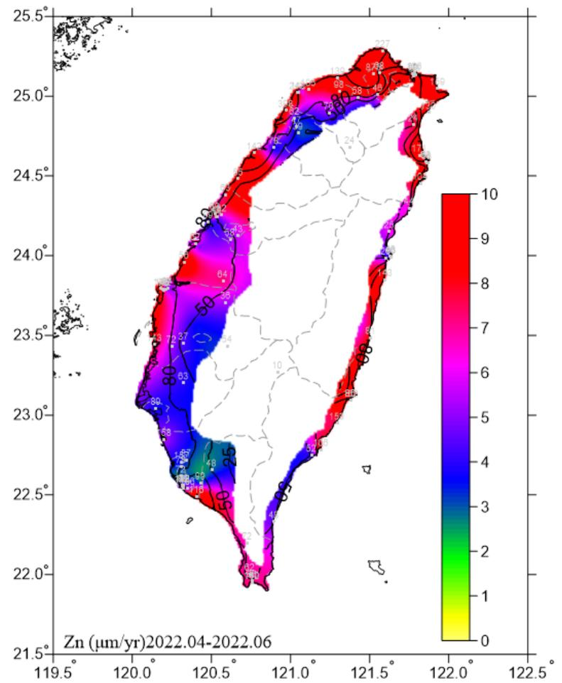
圖 6.14 2022.04-2022.06 鋅腐蝕速率圖
