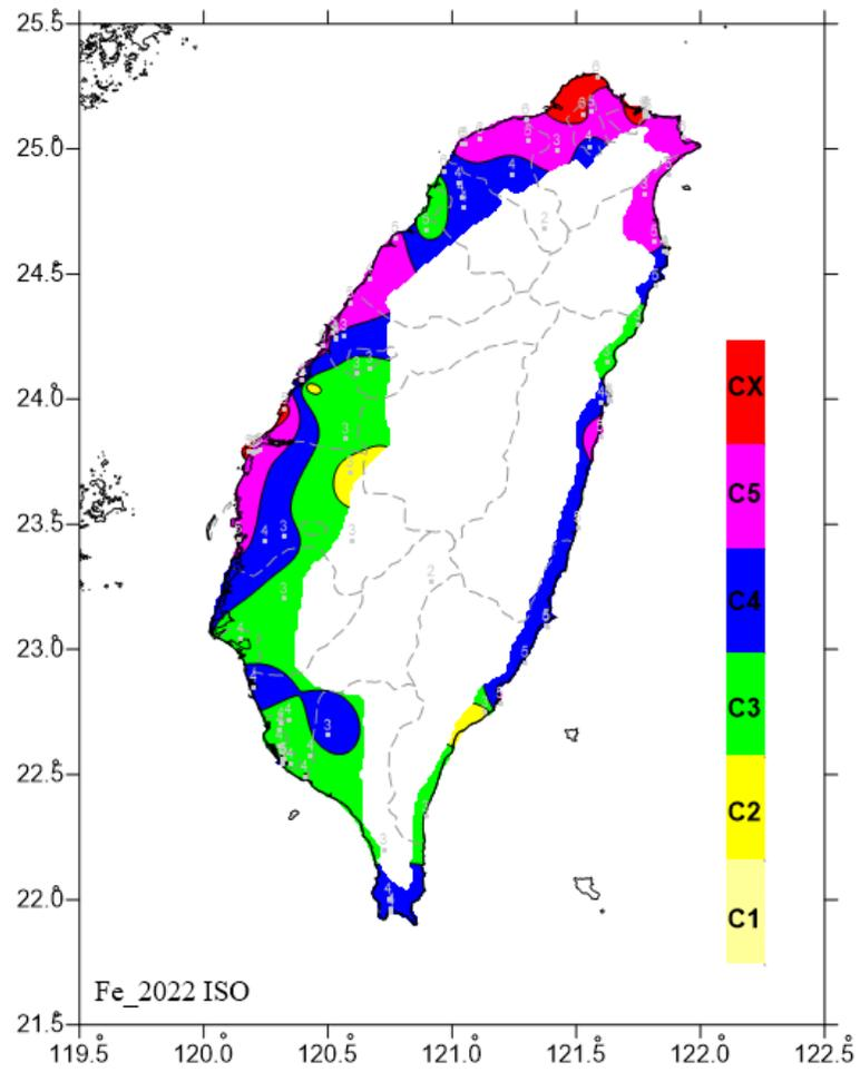
圖 6.29 2022 年碳鋼年腐蝕速率 ISO 分類
