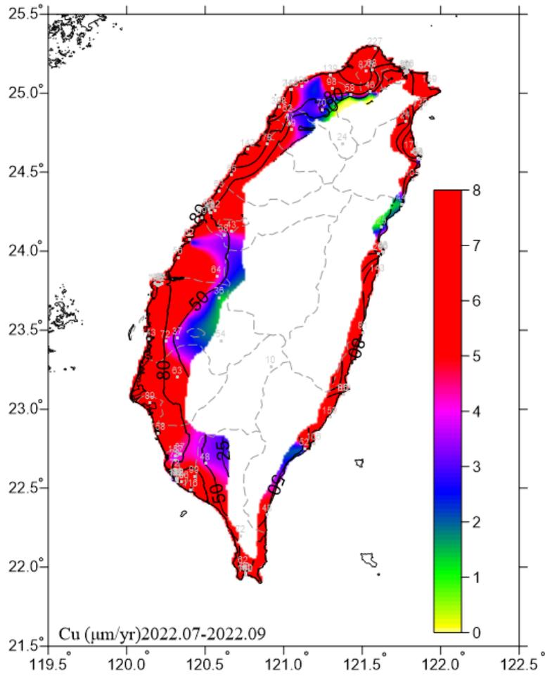
圖 6.19 2022.07-2022.09 銅腐蝕速率圖
