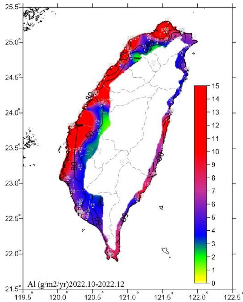
圖 6.24 2022.10-2022.12 鋁腐蝕速率圖
