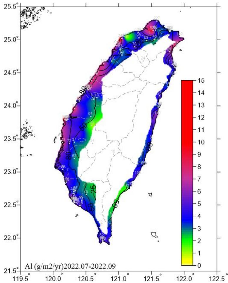
圖 6.23 2022.07-2022.09 鋁腐蝕速率圖
