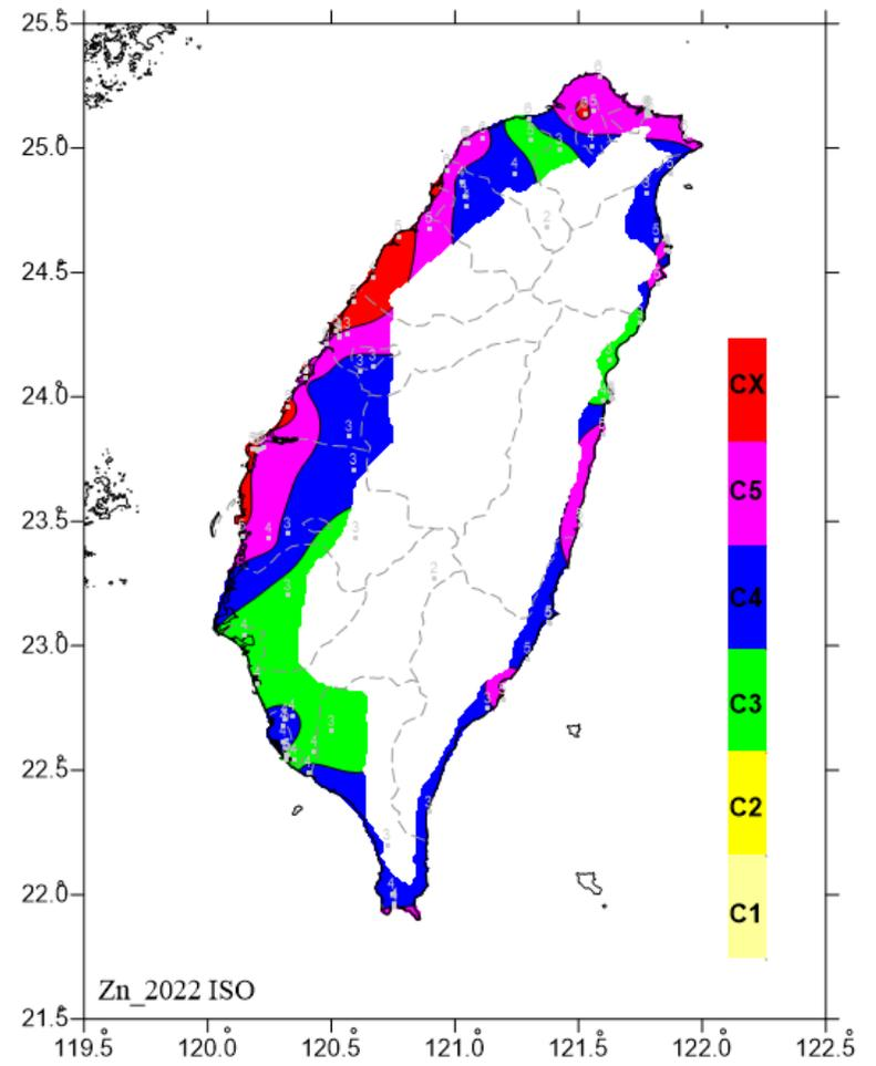
圖 6.30 2022 年鋅年腐蝕速率 ISO 分類圖
