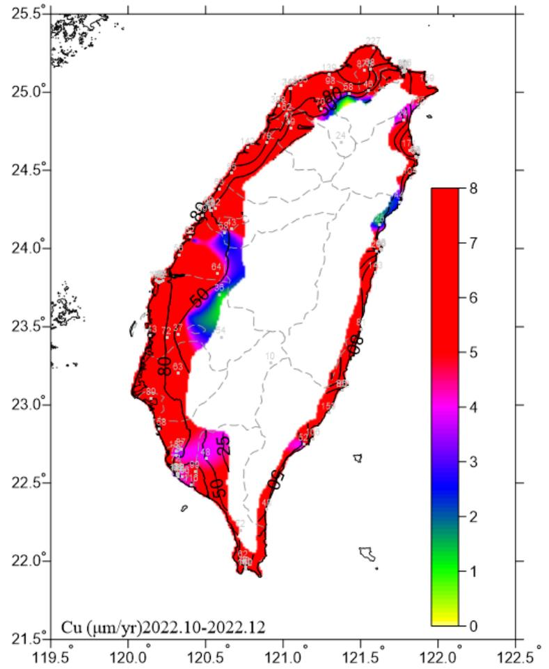
圖 6.20 2022.10-2022.12 銅腐蝕速率圖
