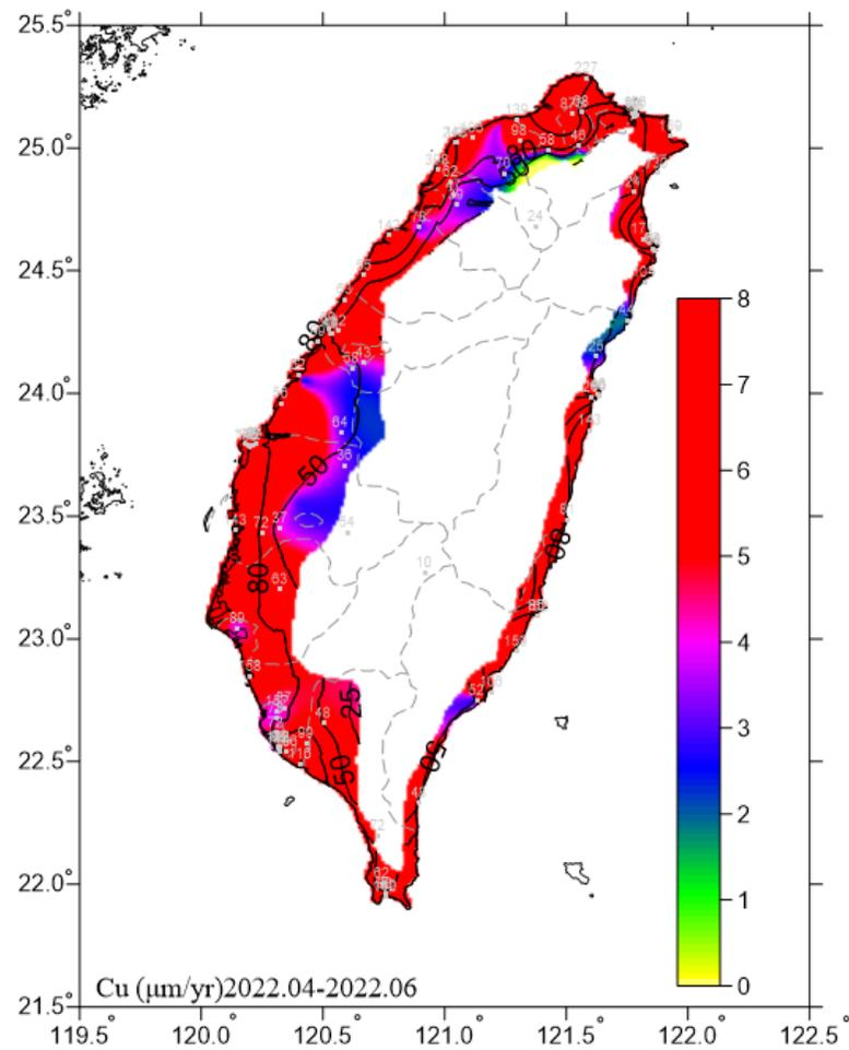
圖 6.18 2022.04-2022.06 銅腐蝕速率圖
