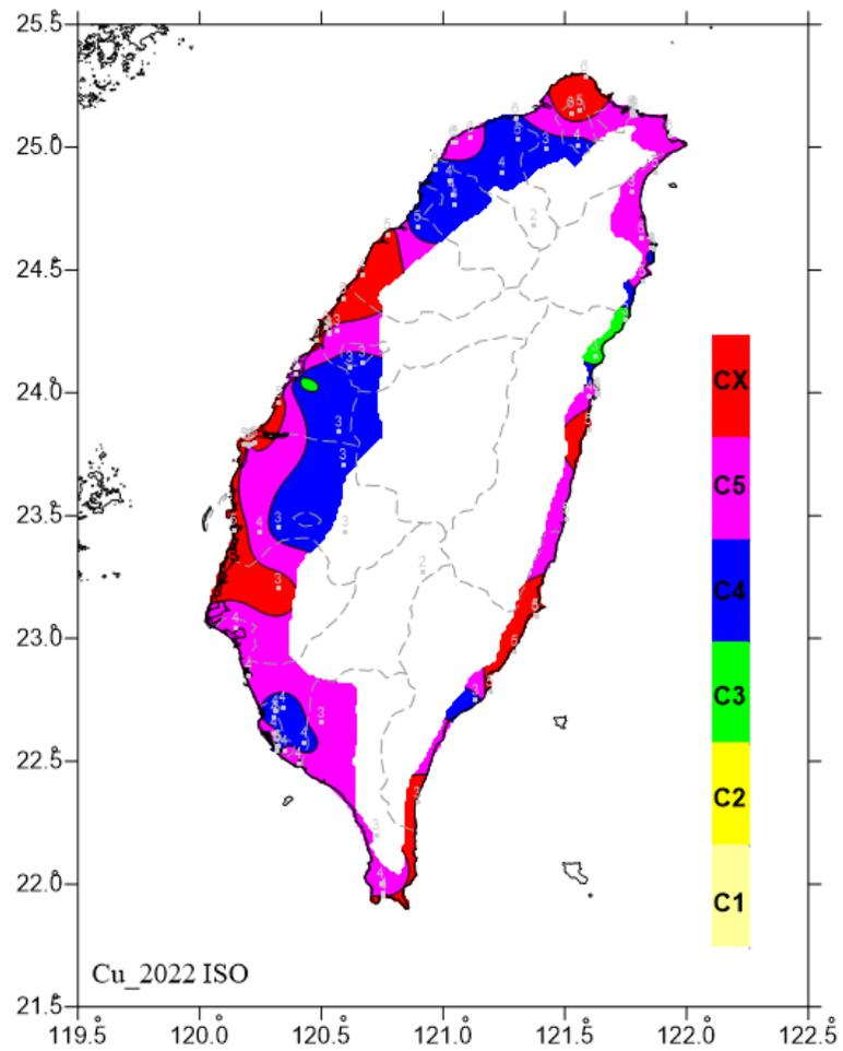
圖 6.31 2022 年銅年腐蝕速率 ISO 分類圖
