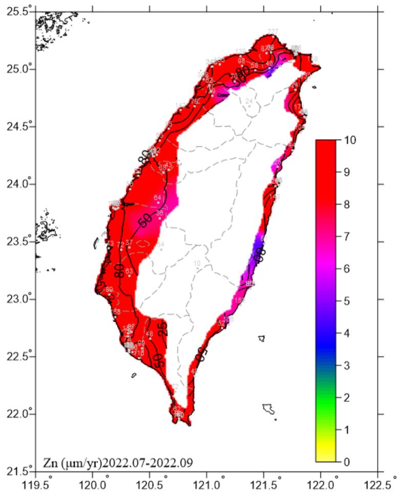
圖 6.15 2022.07-2022.09 鋅腐蝕速率圖
