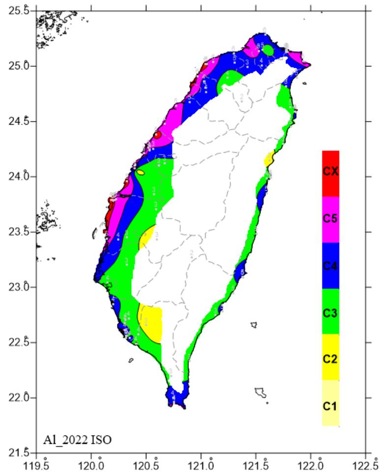
圖 6.32 2022 年鋁年腐蝕速率 ISO 分類圖
