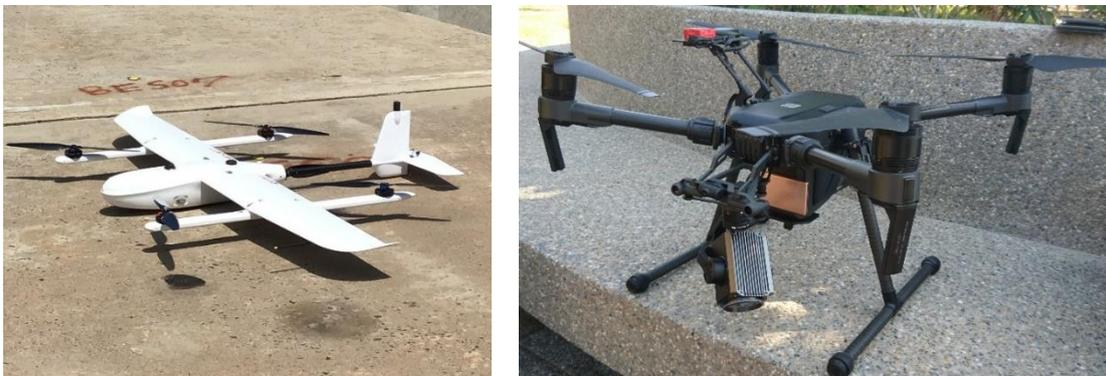
圖 2.1 無人機形式(左：複合式；右：多旋翼式)
