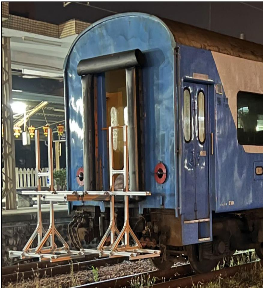
圖 4.1 復興號實車安裝影像採集機構
