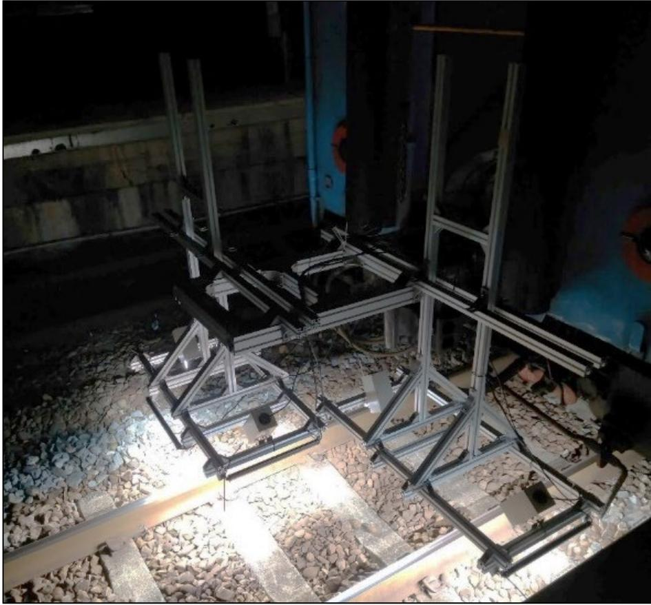
圖 4.2 影像採集機構安裝相機與燈光
