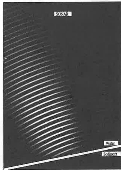
圖3 傾斜海床之散射音場反應圖。標示 SONAR 處為聲納音束之發射位置。
