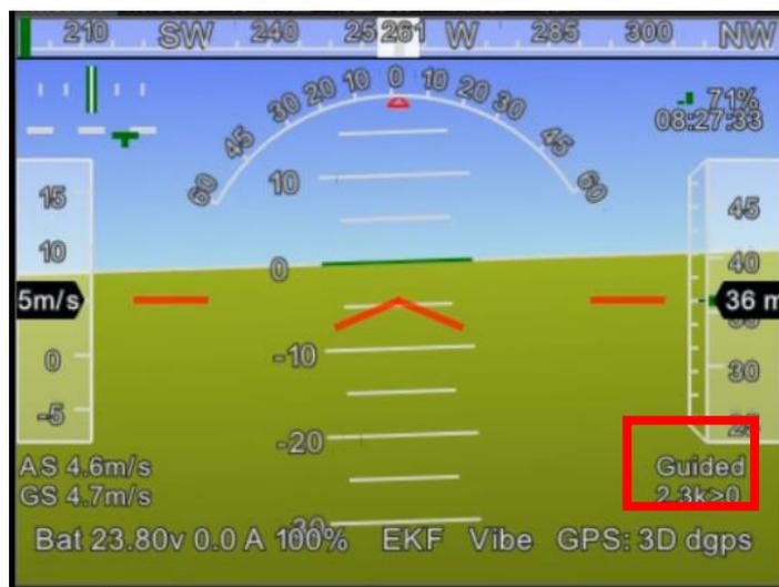
圖 5.33 目標船舶點距離顯示
