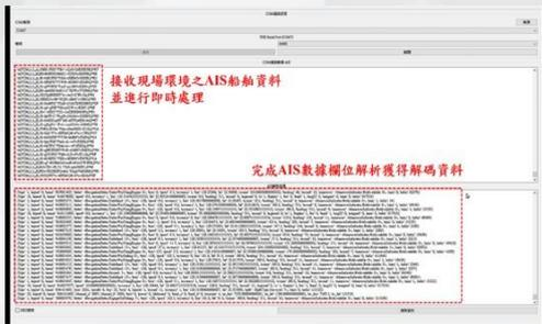
為改善AIS資料延遲性問題，並降低AIS資料數據量過大造成系統負擔之情形，此次系統實測過程，研究藉由系統平台接收現場架設AIS接收站之船舶AIS資料，並進行即時性的數據欄位解析、解碼。
