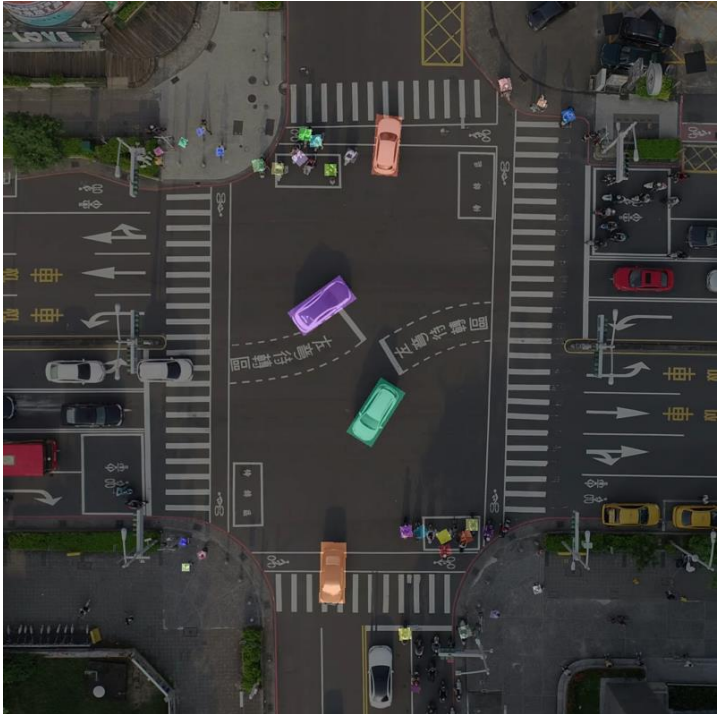
圖 2 汽車、機車、行人的自動辨識
