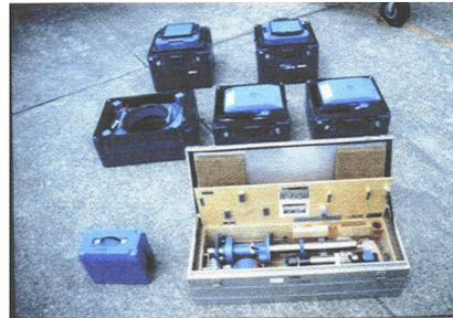
圖四 精密航空測量專用照相機
