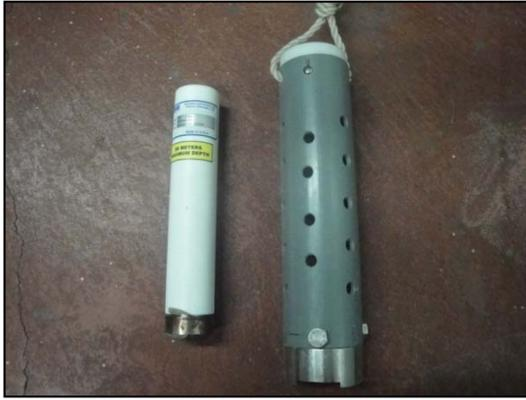
圖 9 Sea-Bird 壓力式自計溫深儀
