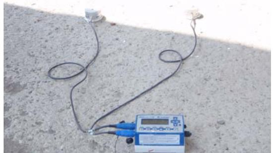
圖 19 三軸向速度規擺設情形
