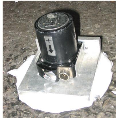
圖 3. VSE-15A 速度型感應器
