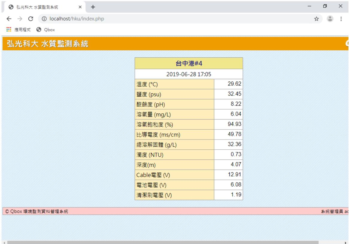
圖 4.41 即時水質監測數據顯示介面
