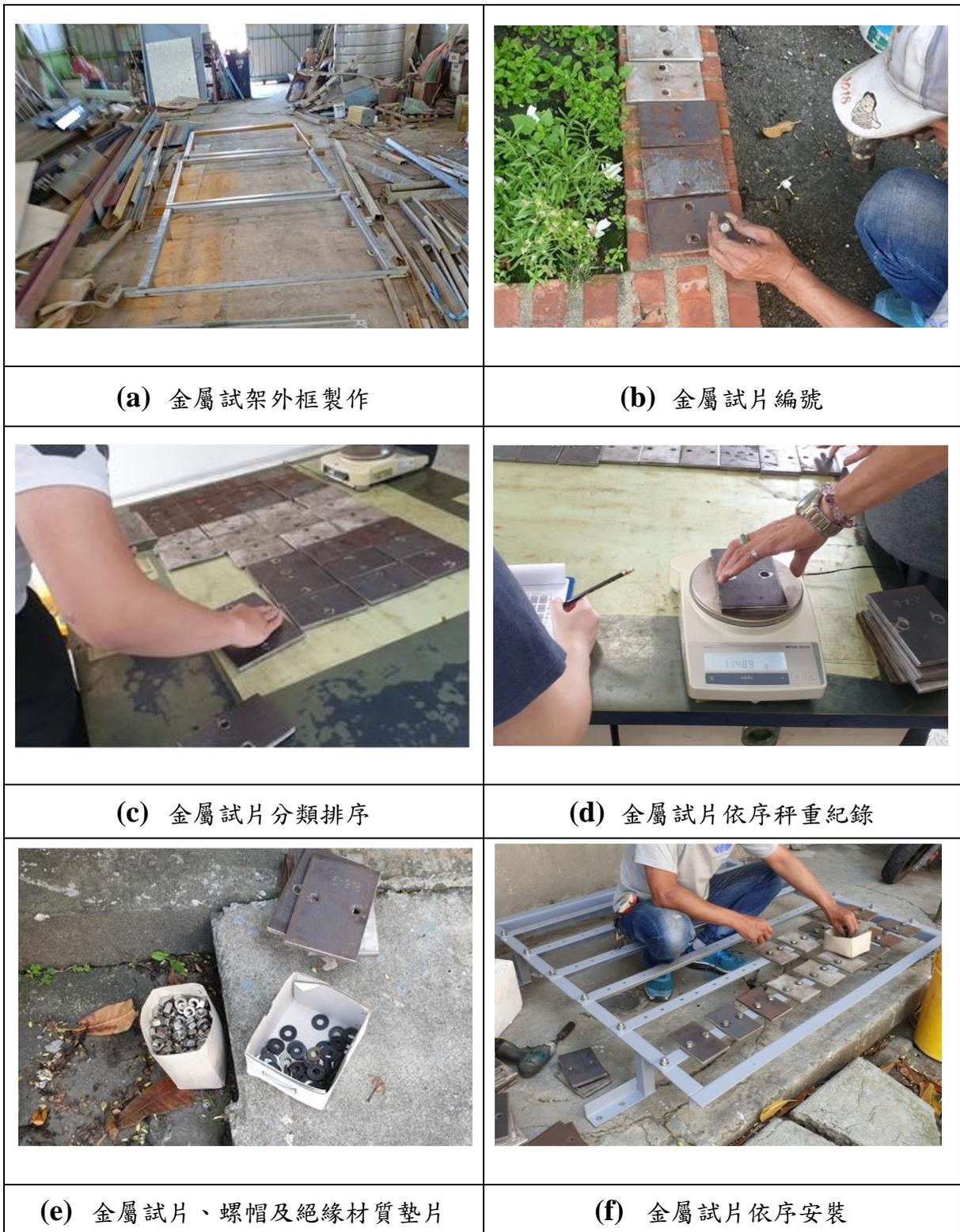
圖 3.5 金屬試片前處理流程與安裝 (108 年 4 月 23 日)
