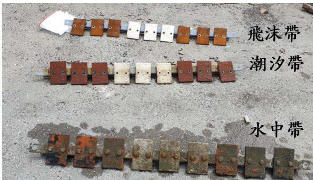
圖 3.7 暴露區域之金屬試片樣品
