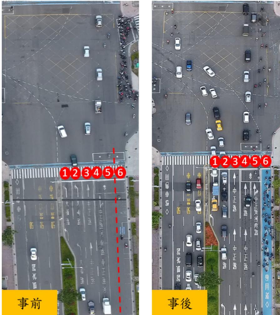
圖 5-10 中正一路與大順三路口路型配置圖(左：事前，右：事後)
